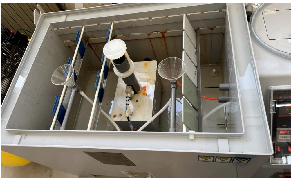
Slika 26. Slana komora Katedre za zaštitu materijala FSB-a
