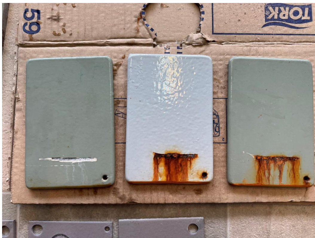
Slika 28. Uzorci nakon 1440 sati u slanoj komori (s lijeva na desno M, PX, P)
