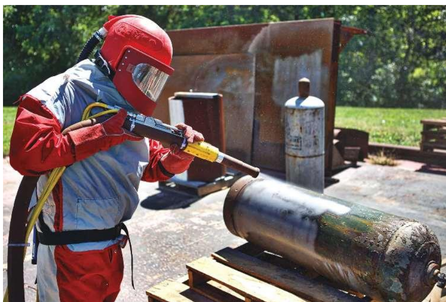
Slika 7. Čišćenje mokrim mlazom abraziva [12]
