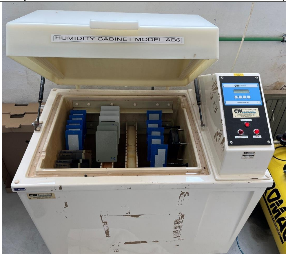
Slika 29. Vlažna komora Katedre za zaštitu materijala FSB-a
