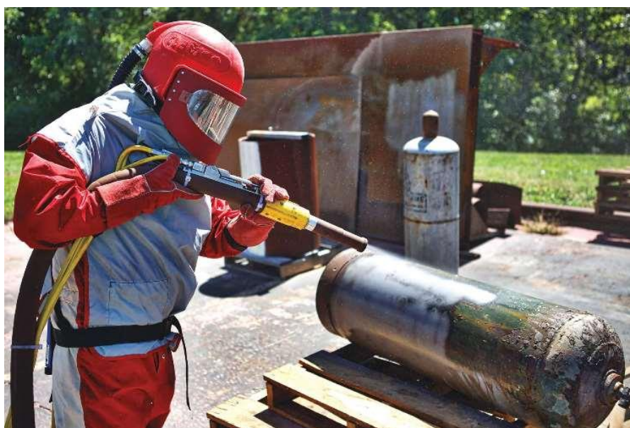
Slika 7. Čišćenje mokrim mlazom abraziva [12]
