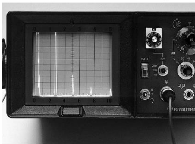
Slika 4. A-prikaz na ultrazvučnom uređaju [2]
