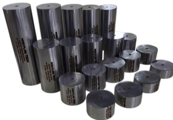
Slika 6. Kalibracijski blokovi s uvrtime s ravnim dnom [6]
