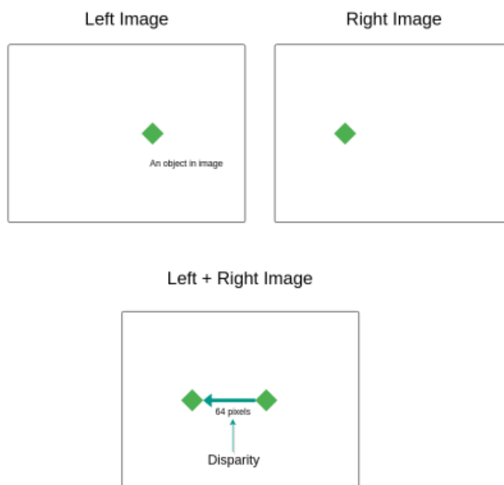
Slika 1. Princip stereo vizije [1]
