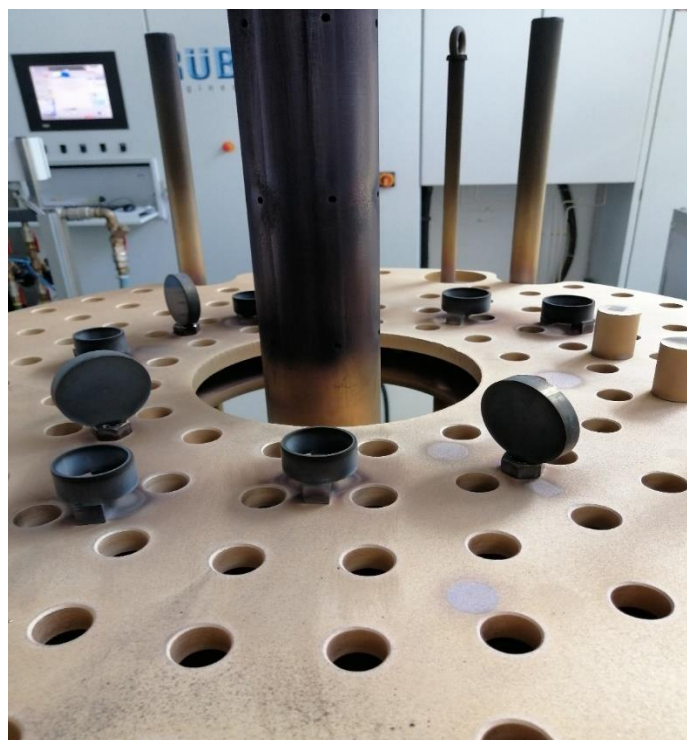
Slika 29. Ispitni uzorci od čelika 100Cr6 nakon nitiranja u plazmi pri 480°C/7h
