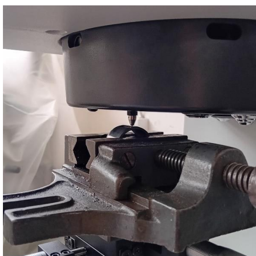
Slika 38. Mjerenje tvrdoće unutarnjeg prstena
