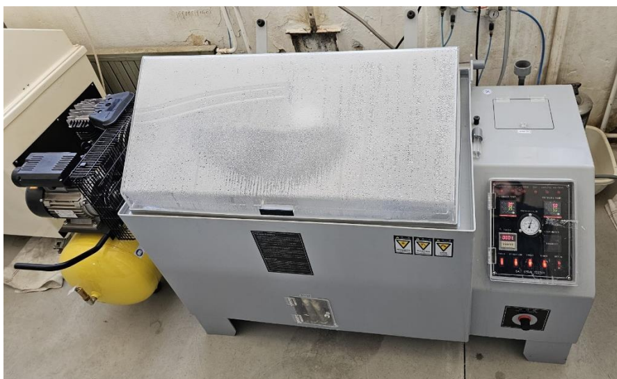
Slika 68. Slana komora, Laboratorij za zaštitu materijala, Fakultet strojarstva i brodogradnje
