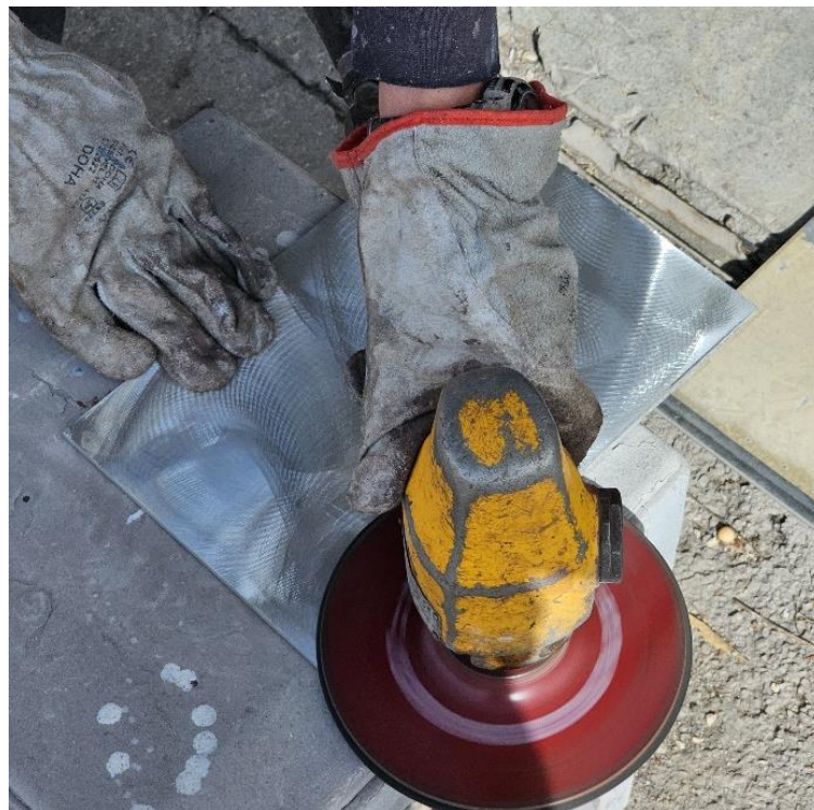
Slika 39. Obrada površine pneumatskom brusilicom
