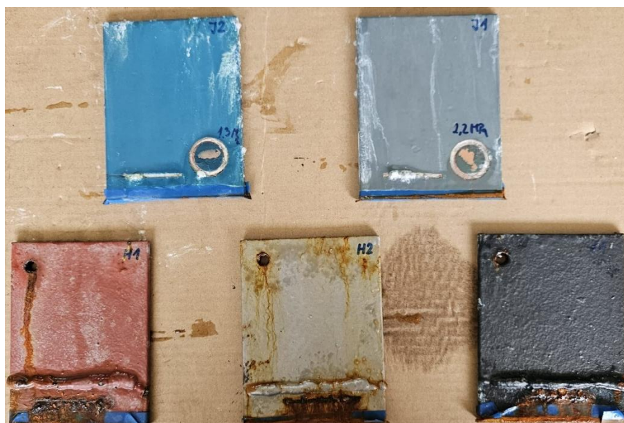
Slika 72. Izgled uzoraka nakon 1440 sati u slanoj komori
