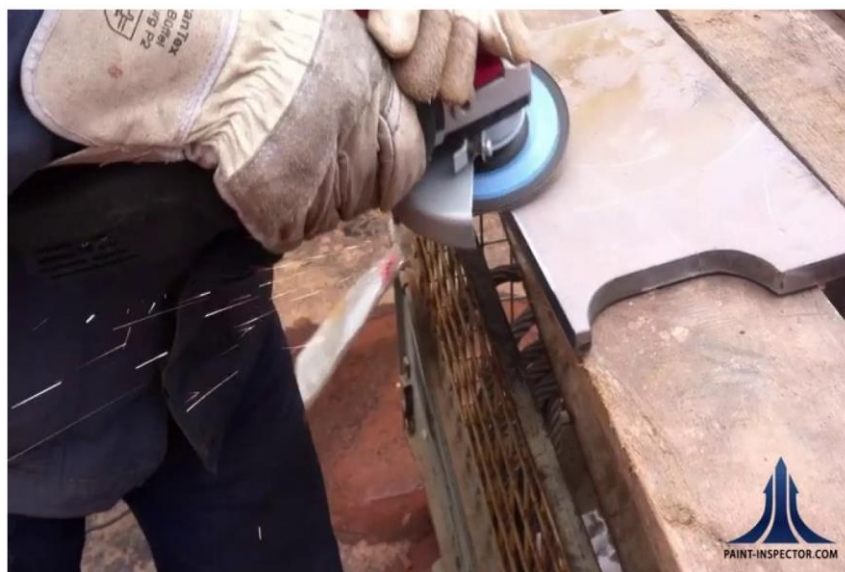
Slika 11. Primjer obrade rubova profila brusilicom [7]
