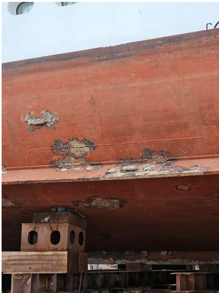
Slika 14. Propadanje sustava premaza zbog utjecaja obraštaja
