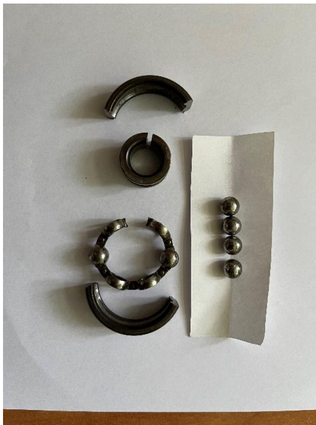
Slika 29. Izrezani uzorak B1 (FAG6301) pripremljen za ispitivanje mikrostrukture i analizu istrošenih površina
