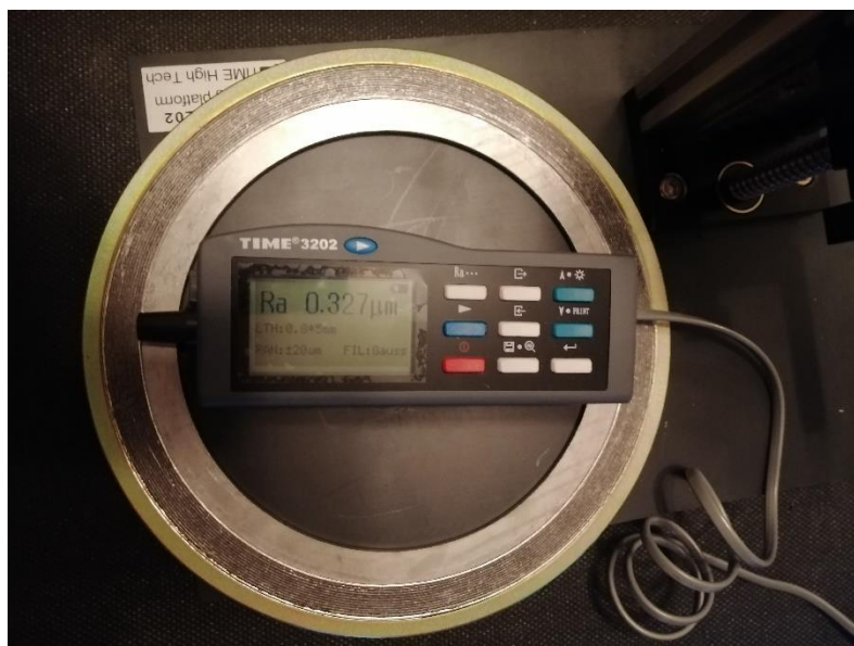
Slika 43. Elektromehanički uređaj s ticalom TIME 3202
