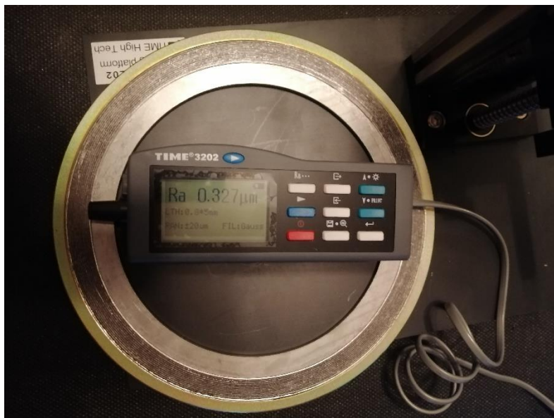
Slika 43. Elektromehanički uređaj s ticalom TIME 3202
