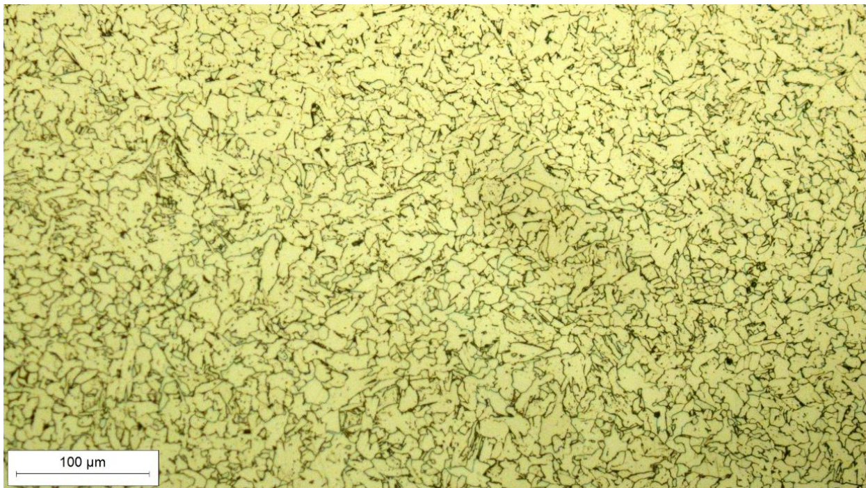
Slika 33. Mikrostruktura uzorka A4, povećanje 500x
