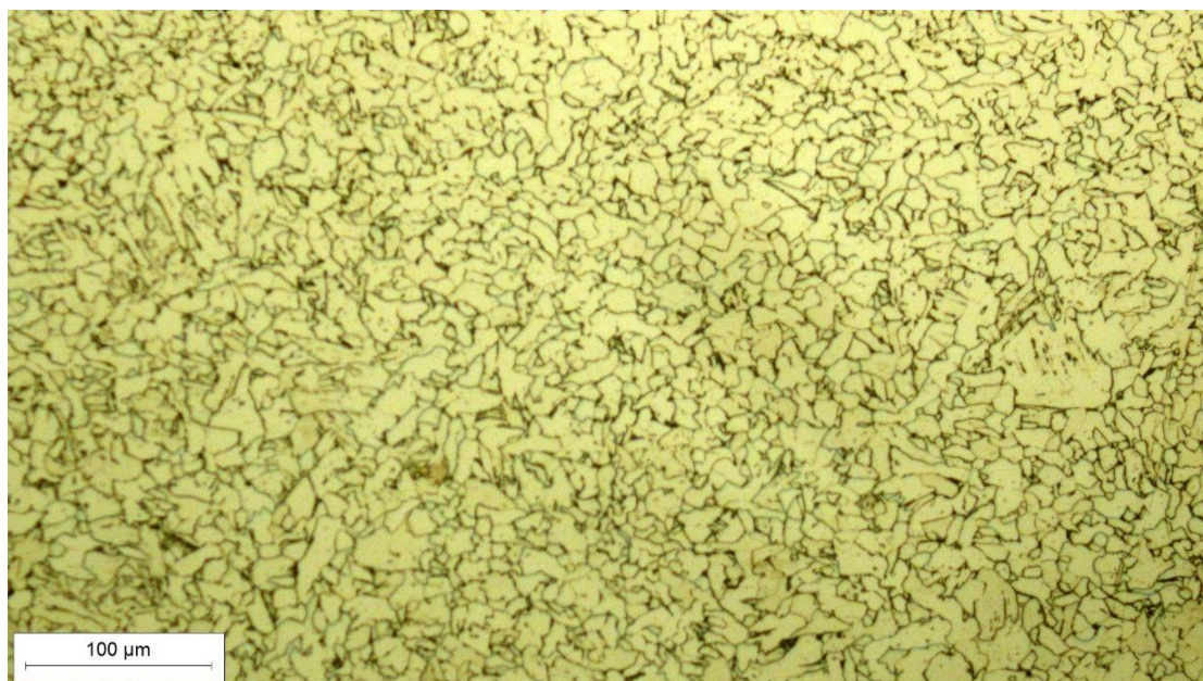
Slika 37. Mikrostruktura uzorka C3, povećanje 500x
