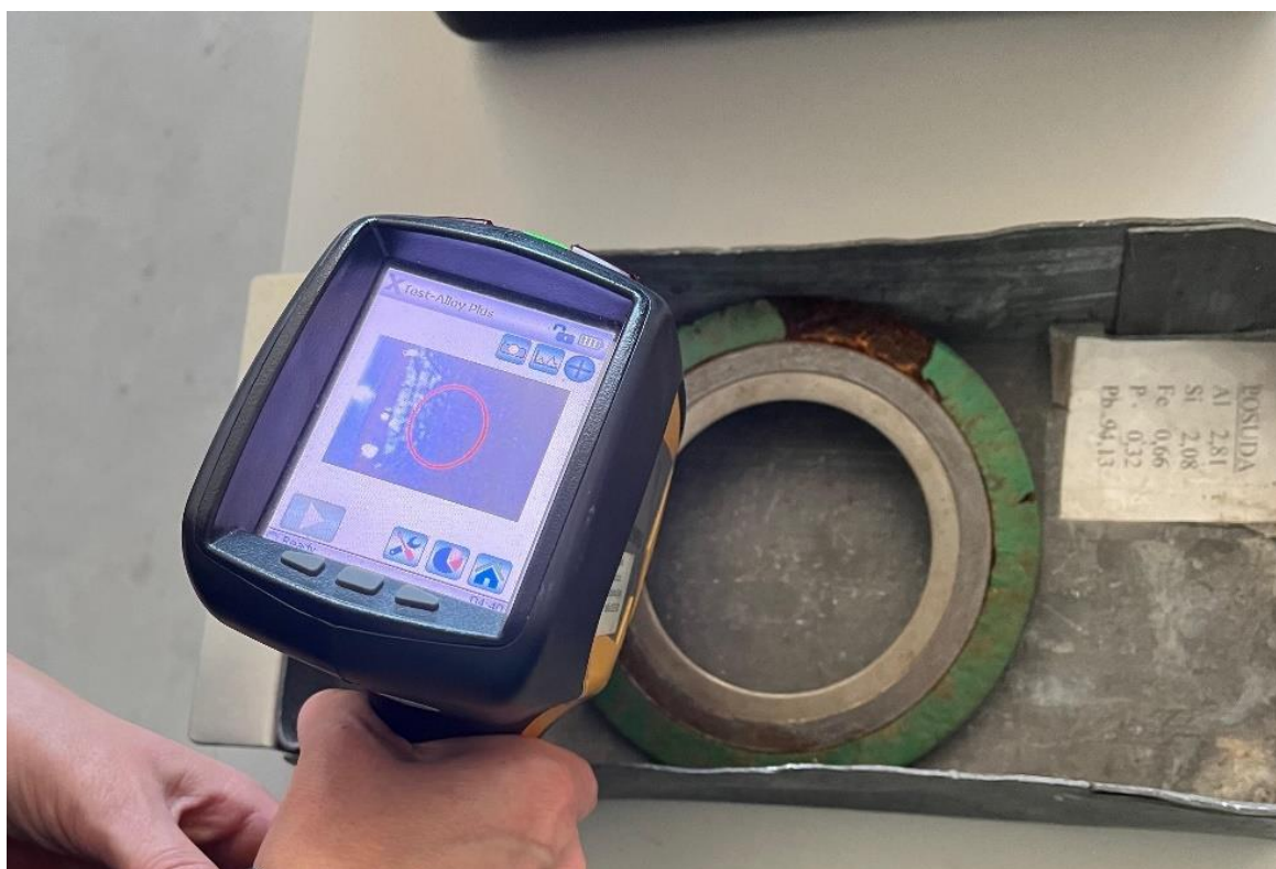
Slika 26. Određivanje kemijskog sastava vanjskog prstena brtve C2
