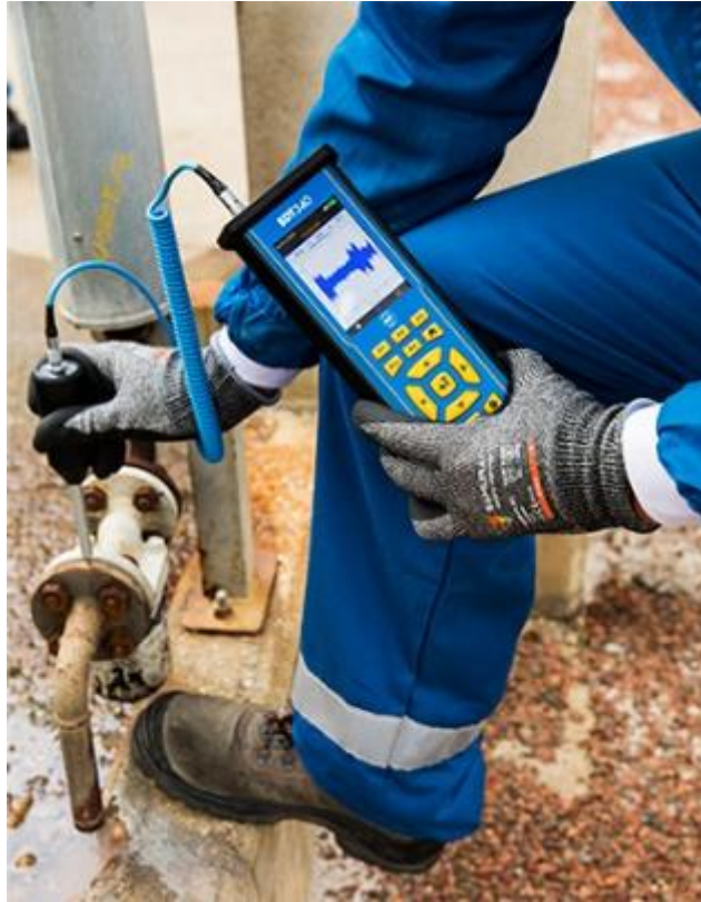
Slika 11. Ultrazvučna inspekcija parne zamke [10]
