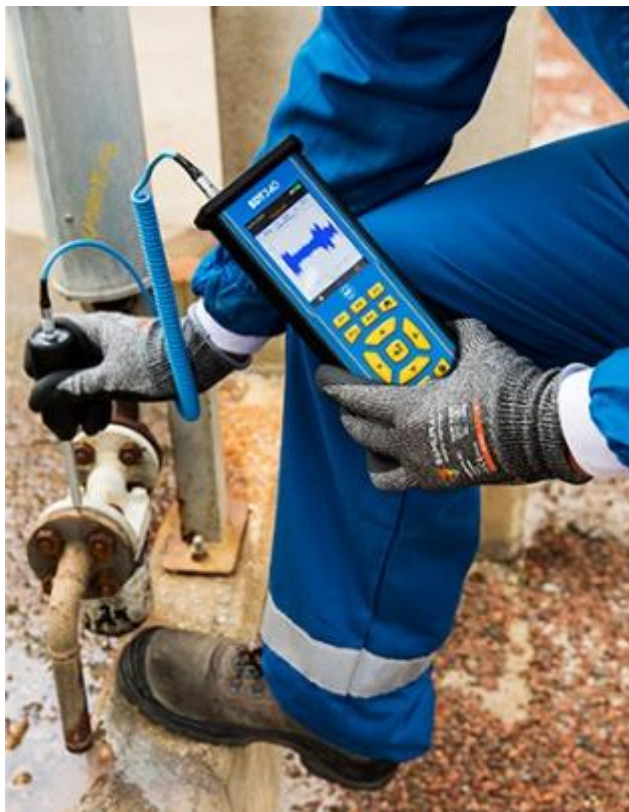
Slika 11. Ultrazvučna inspekcija parne zamke [10]
