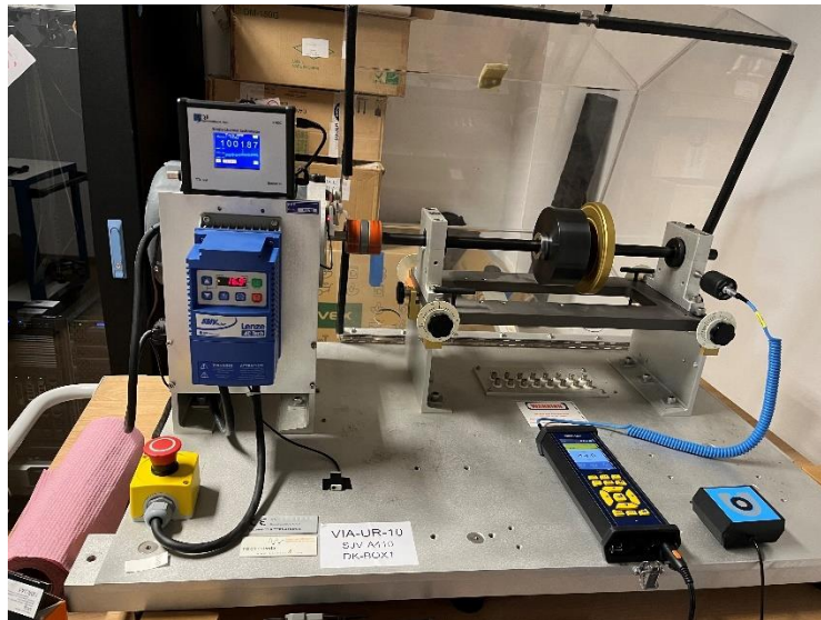
Slika 26. Simulator kvarova ležaja
