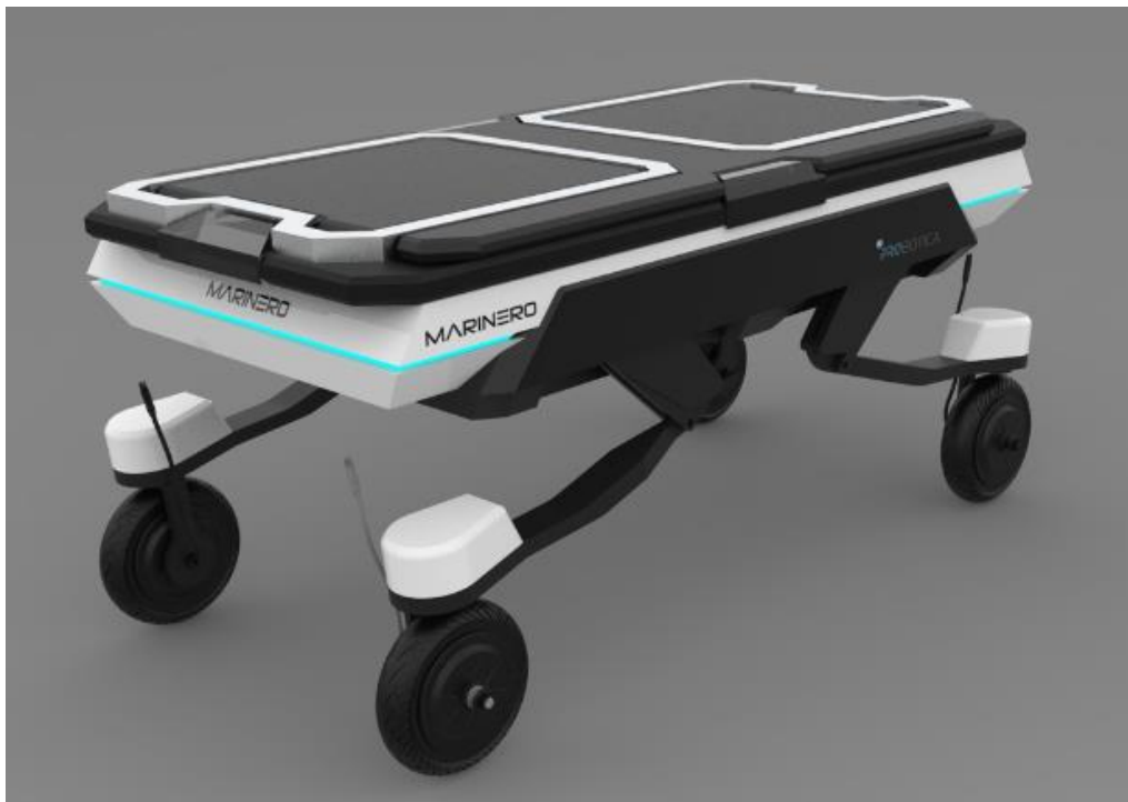
Slika 3. Koncept mobilnog robota predviđenog za korištenje sa sustavom za identifikaciju i lokalizaciju brodova
