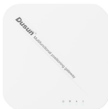
Slika 41. Dusun IoT AoA BLE lokator [48]
