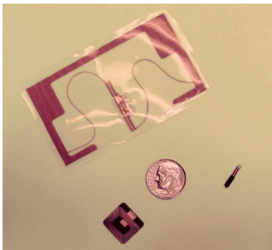
Slika 9. Jednostavna struktura i razne veličine pasivnih RFID odašiljača [13]
