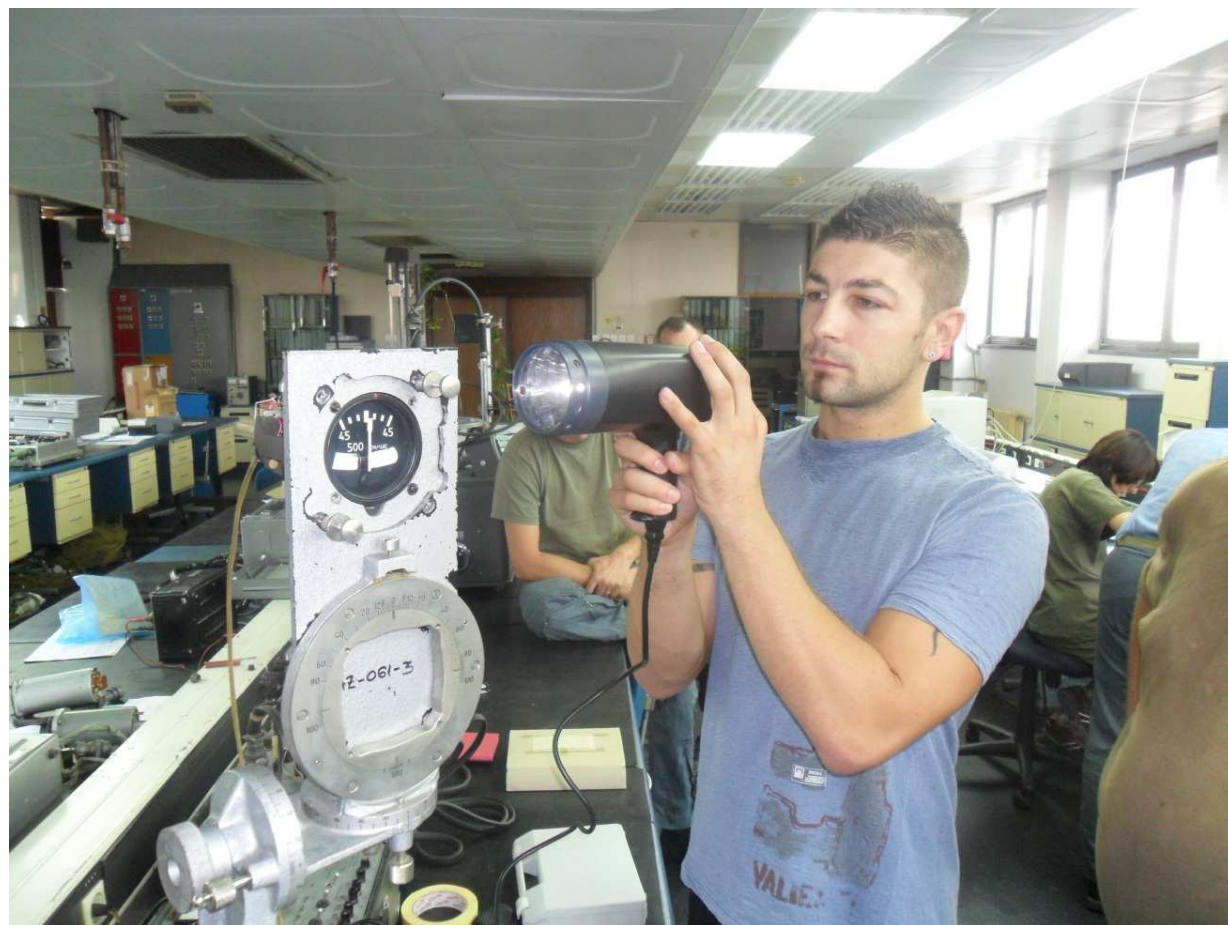
Slika 17. Mjerenje frekvencije rotiranja rotora giroskopa u ZTC d.d.
