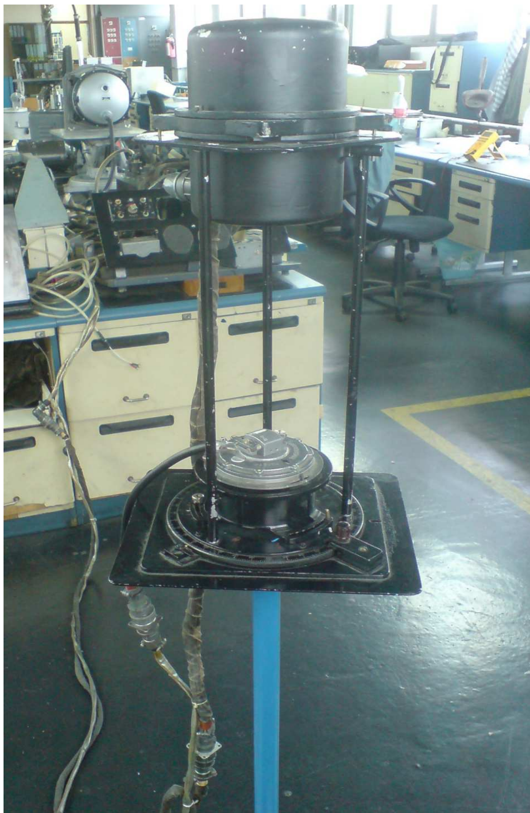
Slika 3. Giromagnetski kompas GMK-1AE na ispitnom postolju u ZTC d.d.
