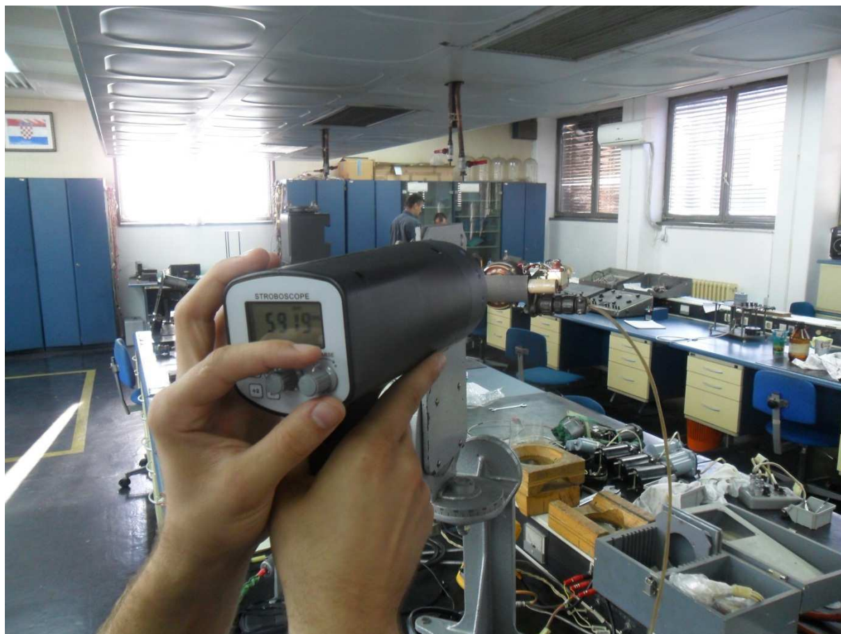
Slika 19. Očitavanje frekvencije rotiranja rotora giroskopa u ZTC d.d.
