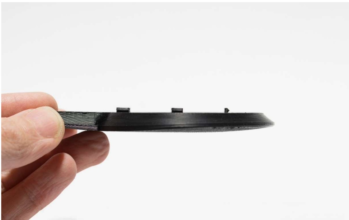
Slika 6. Iskrivljenje površine proizvoda (materijal ABS) [5]
