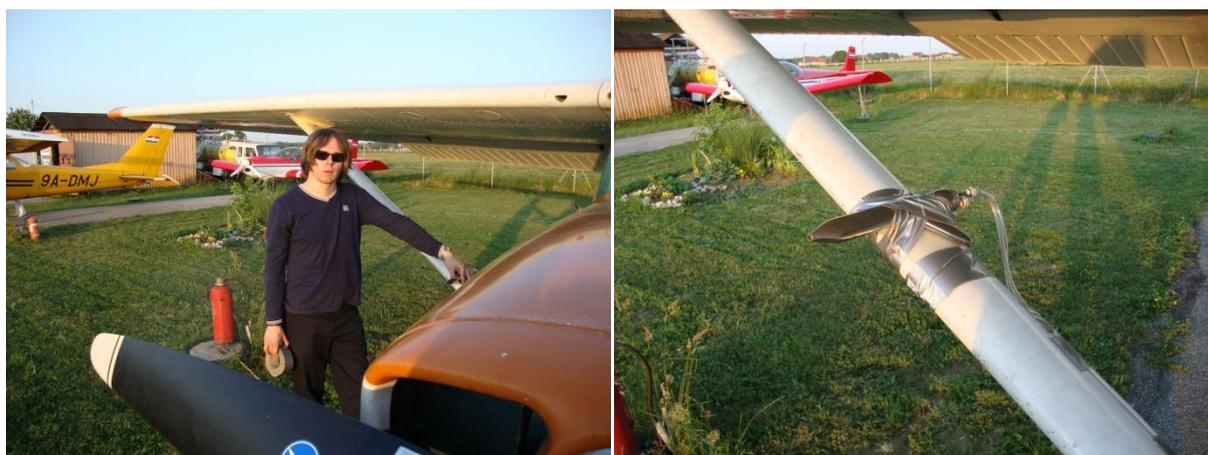
Slika 7.1 a) Montaža Pitot cijevi na desnu upornicu
