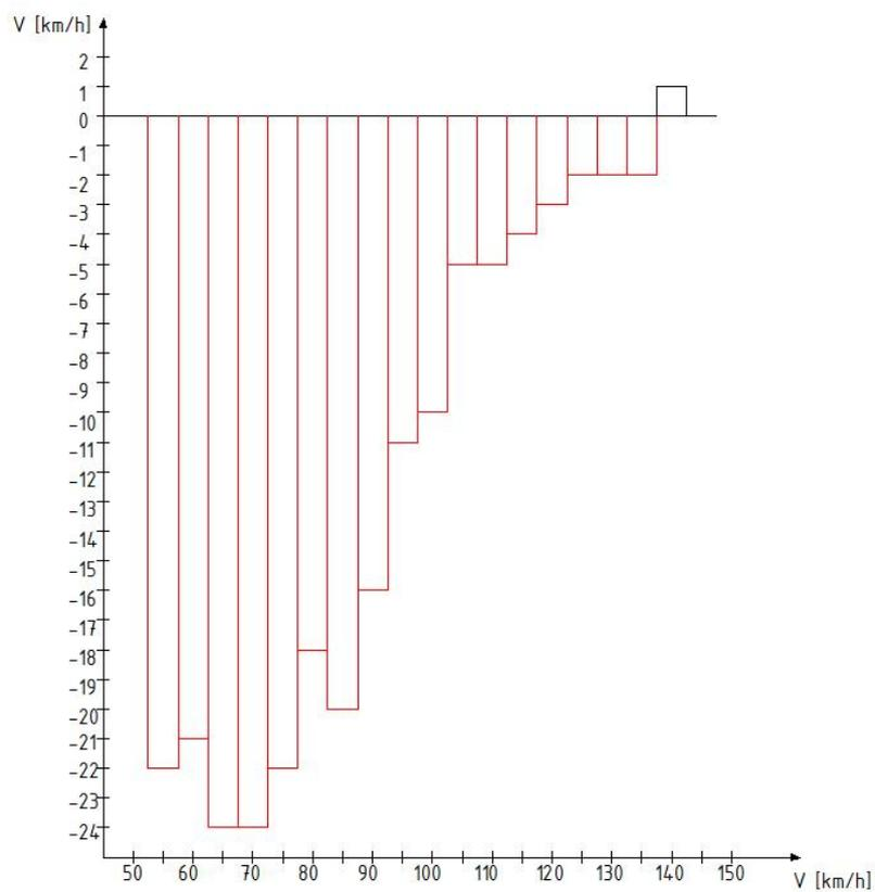
Slika 6.5. Prikaz veličine greške za svaku očitane brzinu, na brzinomjeru automobila
