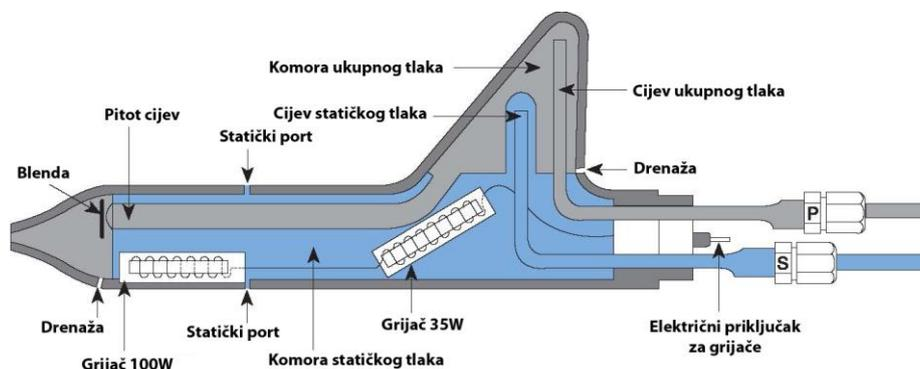
Slika 3.2 Shematski prikaz Kollsmanove pitot cijevi [19]
