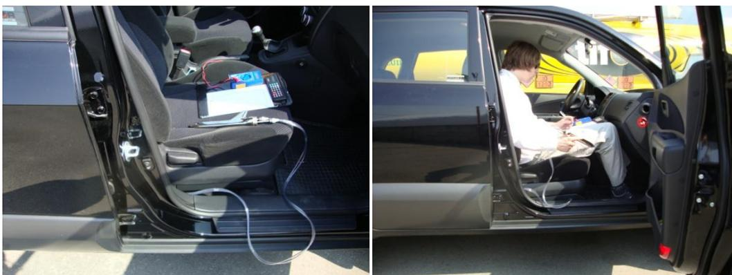
Slika 6.1 a i b ) Oprema za mjerenje postavljena u automobilu
