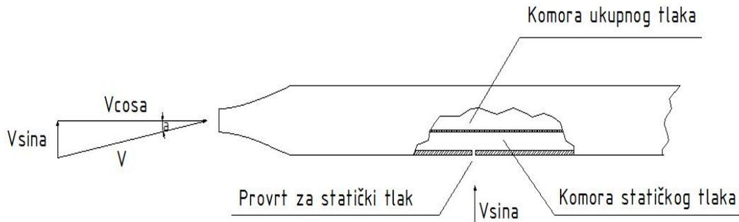
Slika 3.3 Utjecaj komponente aerodinamičke brzine na statički sustav
