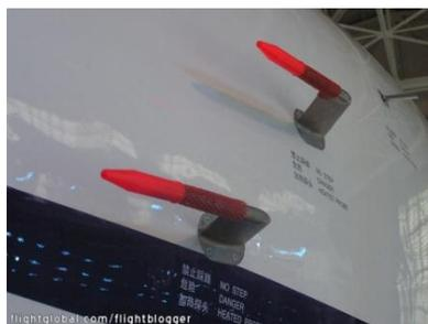
Slika 2.5 Pitot cijevi, modernog transportnog zrakoplova [22]
