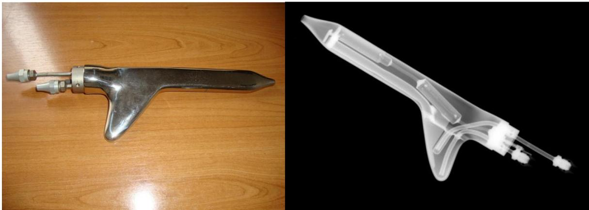
Slika 3.1 a) Kollsmanova cijev pomoću koje je izvršeno mjerenje
