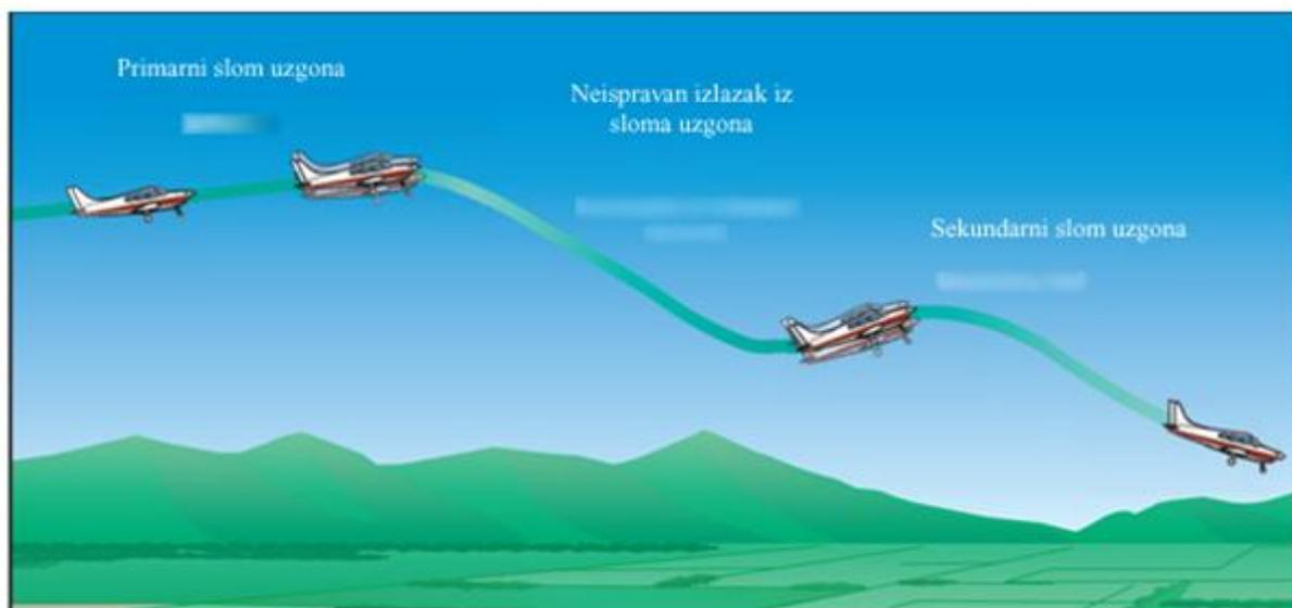
Slika 7.4 Prikaz primarnog i sekundarnog sloma uzgona [3]
