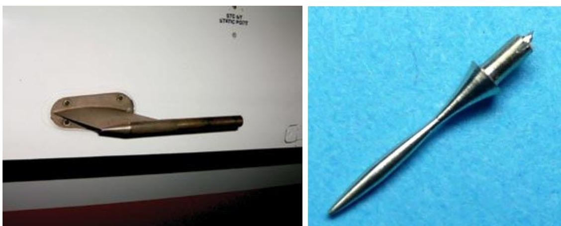
Slika 2.7 a) Pitot cijev za visoko podzvučni zrakoplov [25]
