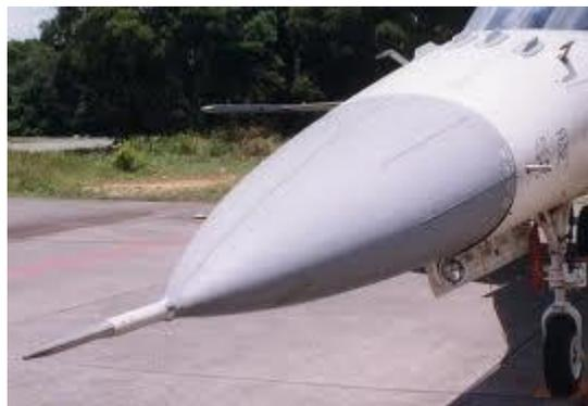
Slika 6.2 Pitot cijevi zrakoplova F-16 [21]
