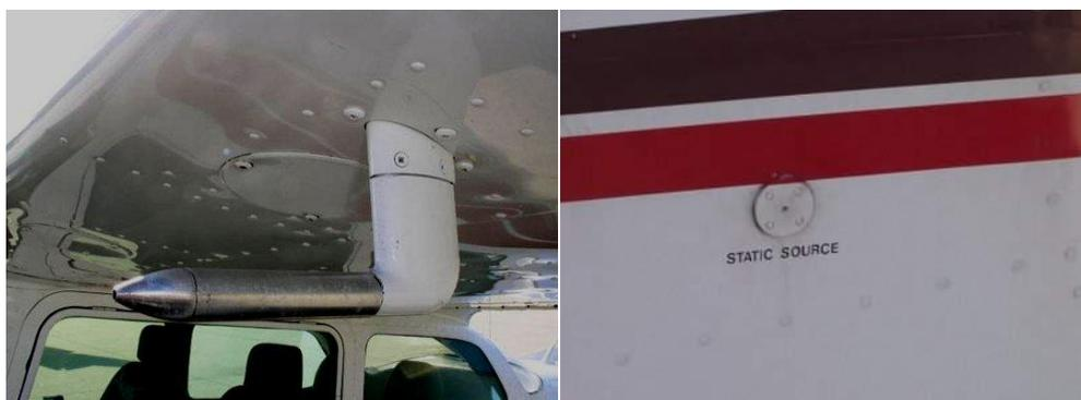
Slika 2.6 a) Pitot cijevi zrakoplova Cessna-172
