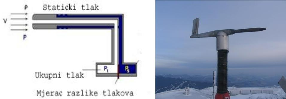
Slika 2.1 a) Shema Pitot-statičkog sustava [1]
