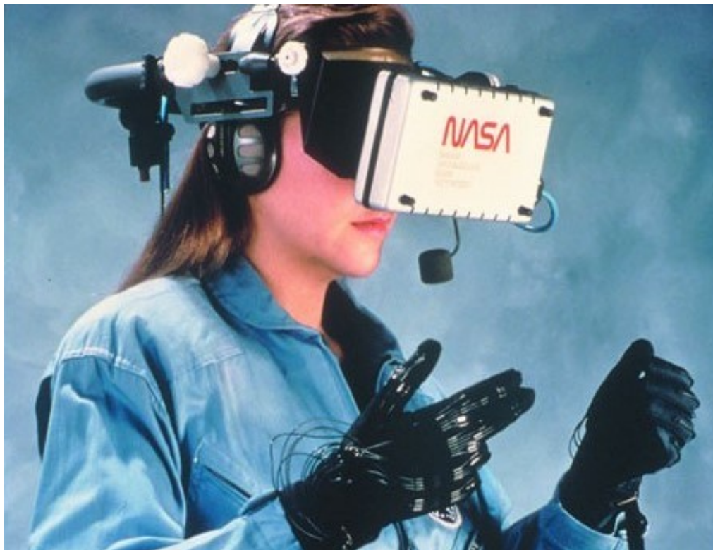
Slika 4. Primjena naočala i rukavica u sklopu projekta „VIEW“ [7]
