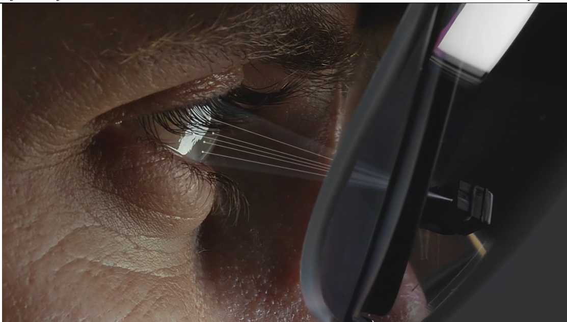
Slika 16. Microsoft HoloLens 2 – mogućnost praćenja očiju [30]
