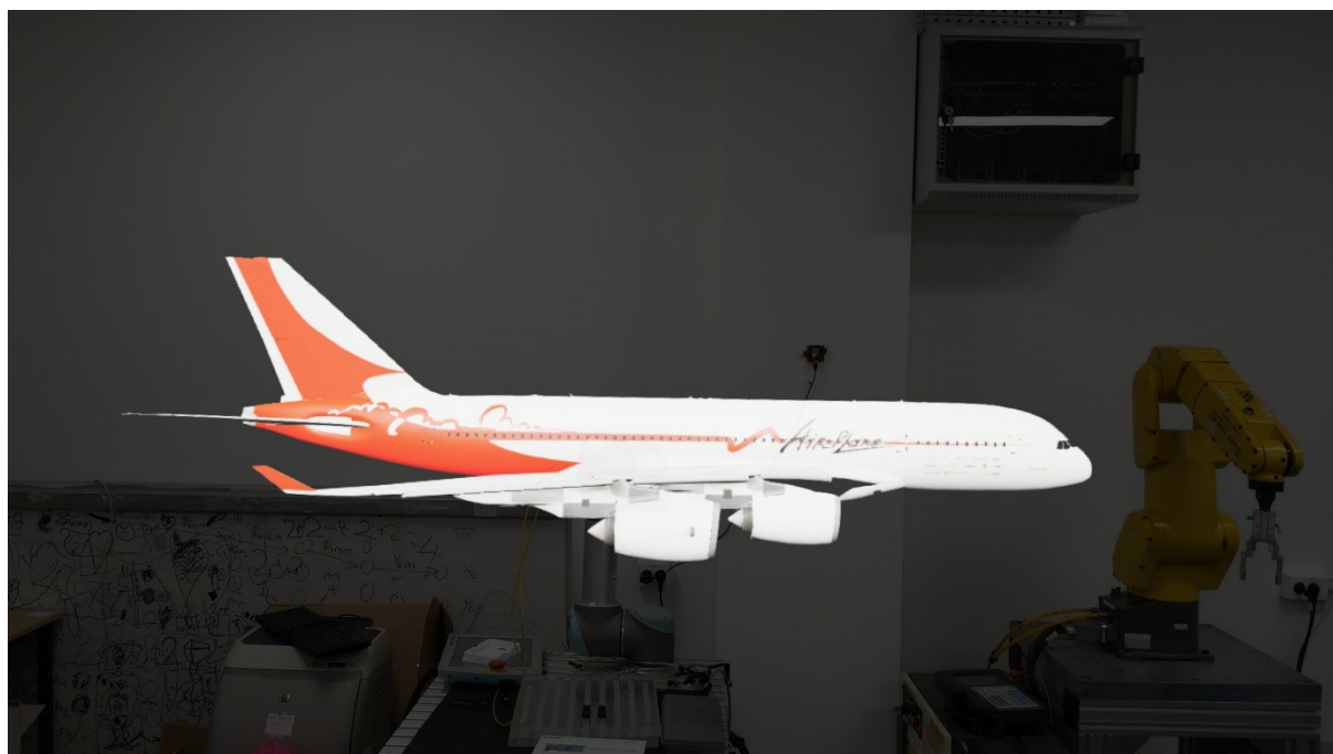
Slika 74. Prikaz virtualnog modela zrakoplova u sustavu mješovite stvarnosti, nakon klika na tipkalo Airplane Visibility
