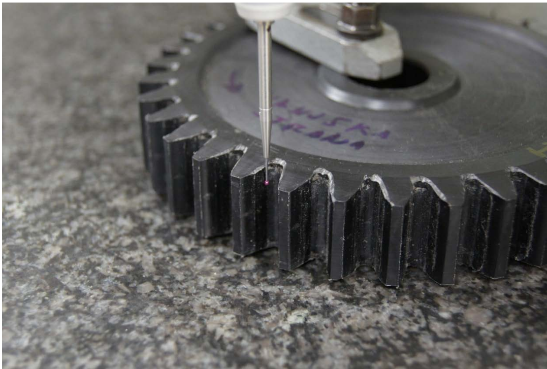
Slika 44. Pozicija ticala u odnosu na zupčanik
