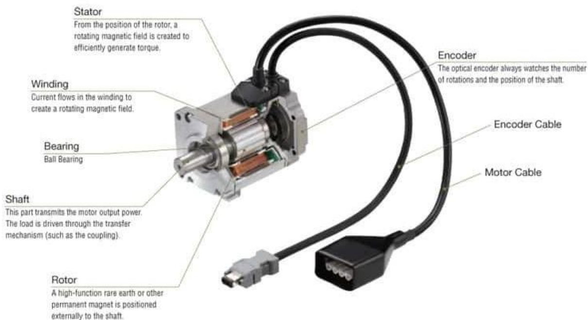
Slika 29. Konstrukcija servo motora [19]
