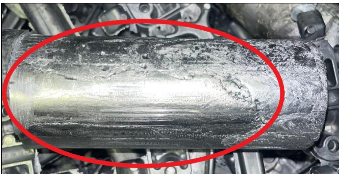
Slika 40 Ponovljeni 'Fill test' – tlačna komora bez zarobljenog zraka
