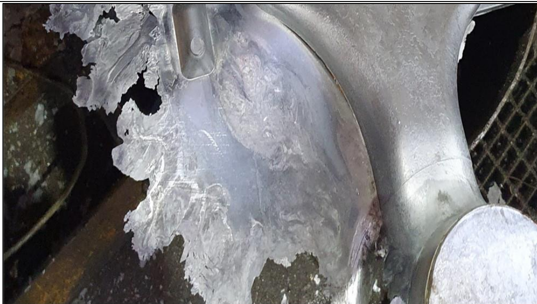
Slika 28 Srh na odljevku
