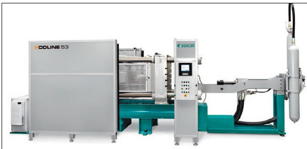
Slika 36 Stroj Bühler Ecoline [24]
