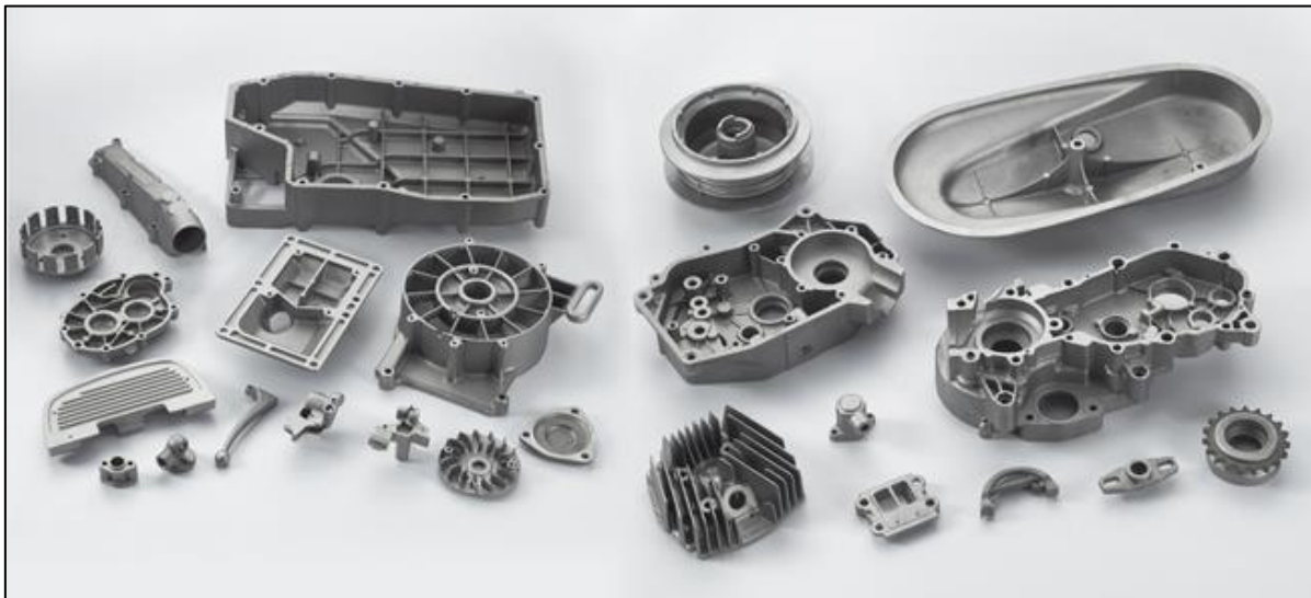
Slika 3 Dijelovi motora automobila dobivenim tlačnim lijevanjem [4]
