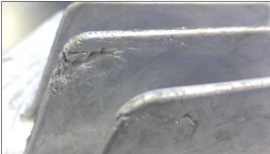
Slika 25 Nedolivenost na odljevku
