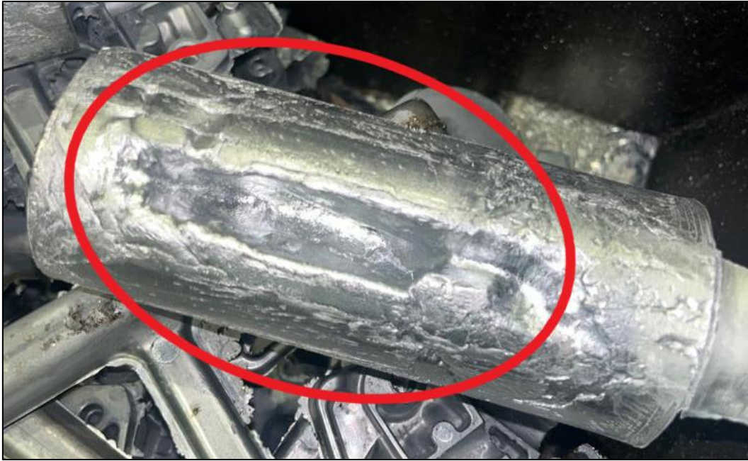
Slika 39 'Fill test' – tlačna komora s puno zarobljenog zraka
