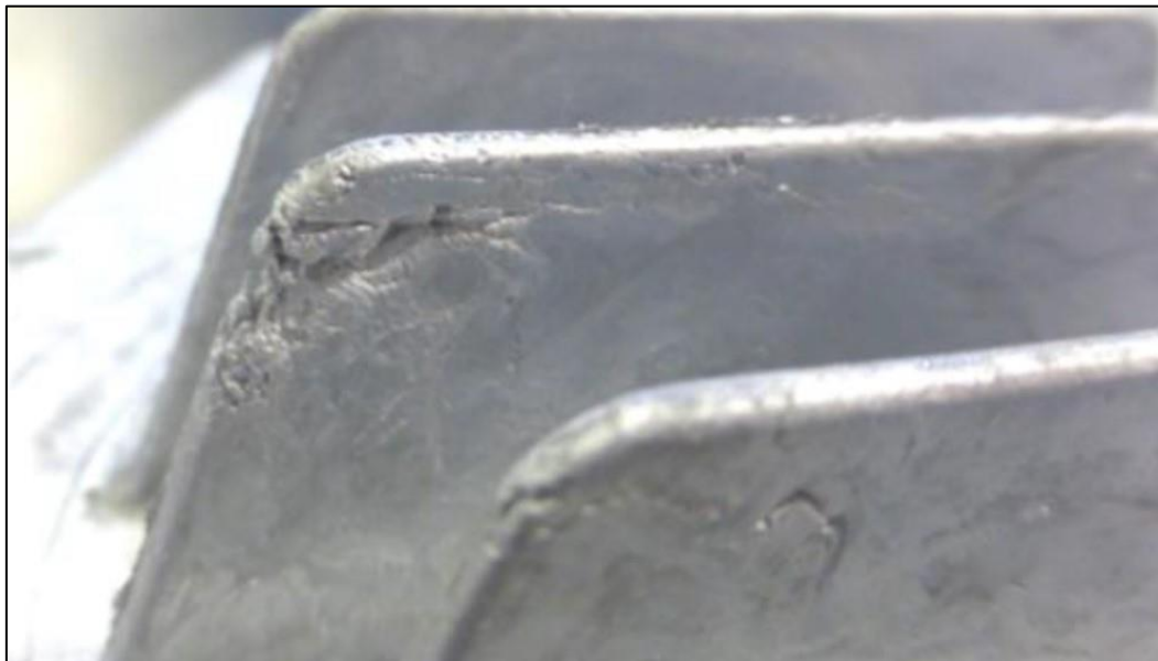
Slika 25 Nedolivenost na odljevku
