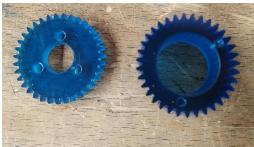
Slika 54 Zupčanci izrađeni korištenjem SLA tehnologije
