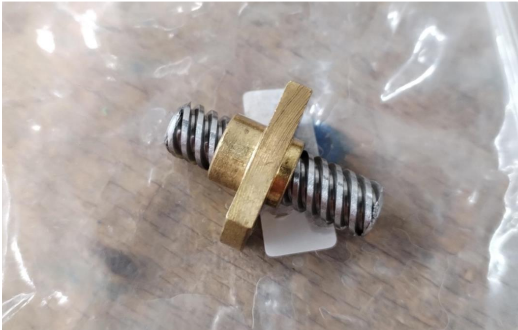
Slika 53 Korištena matica i vreteno
