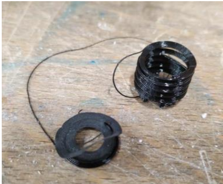
Slika 56 Prva konfiguracija glavne opruge
