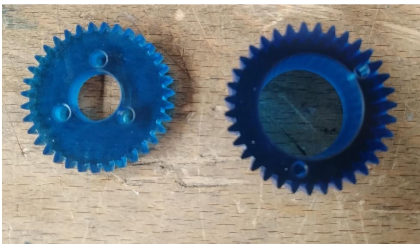
Slika 54 Zupčanci izrađeni korištenjem SLA tehnologije
