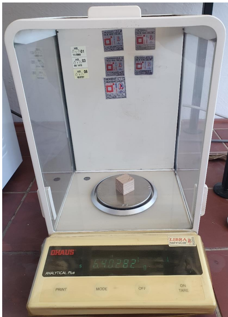
Slika 29. Mjerenje uzorka na analitičkoj vagi
