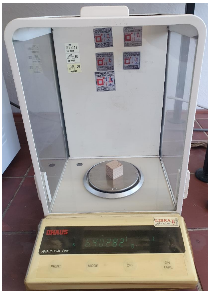
Slika 29. Mjerenje uzorka na analitičkoj vagi
