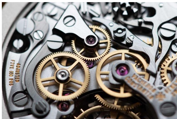
Slika 38. Centralni i pogonski zupčanik [24]
