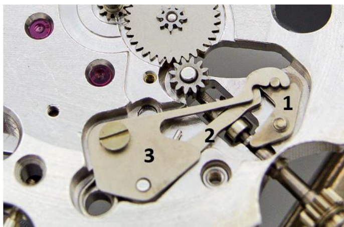
Slika 20. Mehanizam namještanja kazaljki [16]
