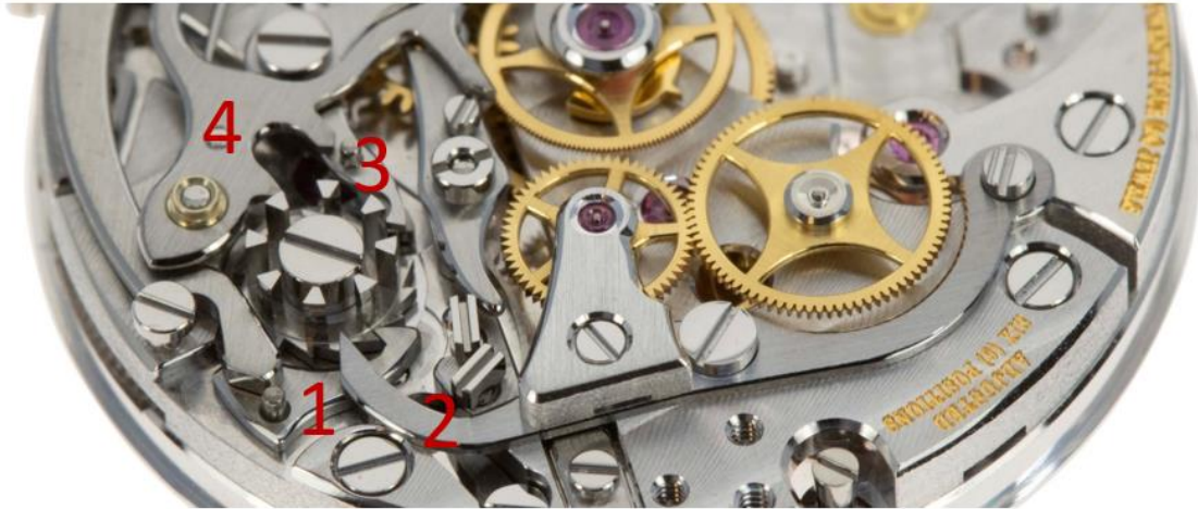
Slika 43. Sklopni zupčanik s polugama [26]
