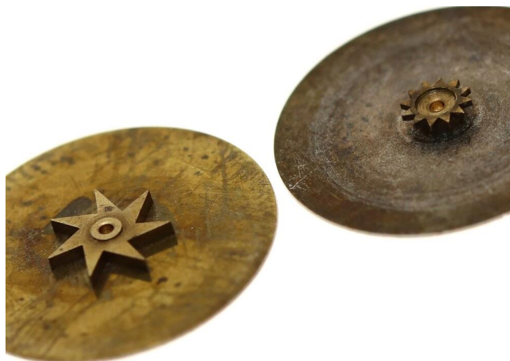
Slika 30. Zvijezde od 7 zubi i od 12 zubi [18]
