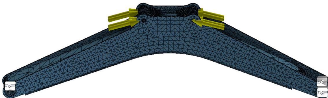
Slika 68. Mreža konačnih elemenata i opterećenja grane
