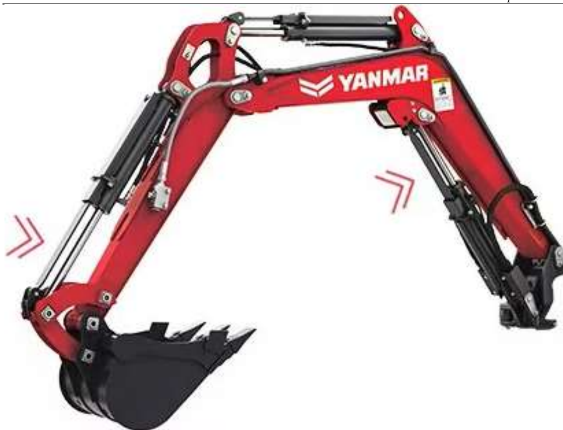
Slika 16. Radni uređaj mini bagera s jednodijelnom granom i sa zaštitama cilindara [23]
