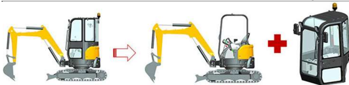
Slika 15. Modularna izvedba za odabir izgleda prostora operatera [22]
