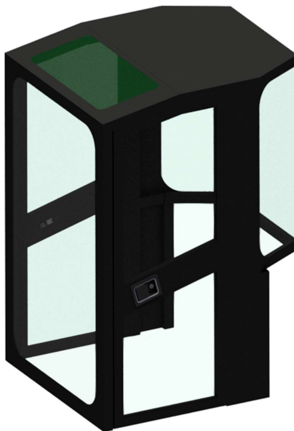
Slika 39. 3D CAD model zatvorene kabine mini bagera
