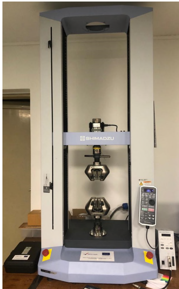
Slika 25. Mehanička kidalica za statičko – vlačna ispitivanja
