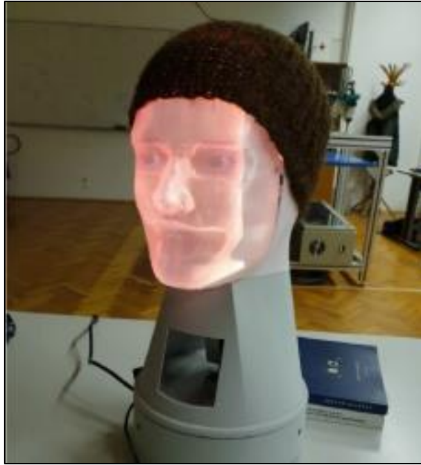
Slika 11 Prototip afektivne humanoidne robotske glave PLEA [26]
