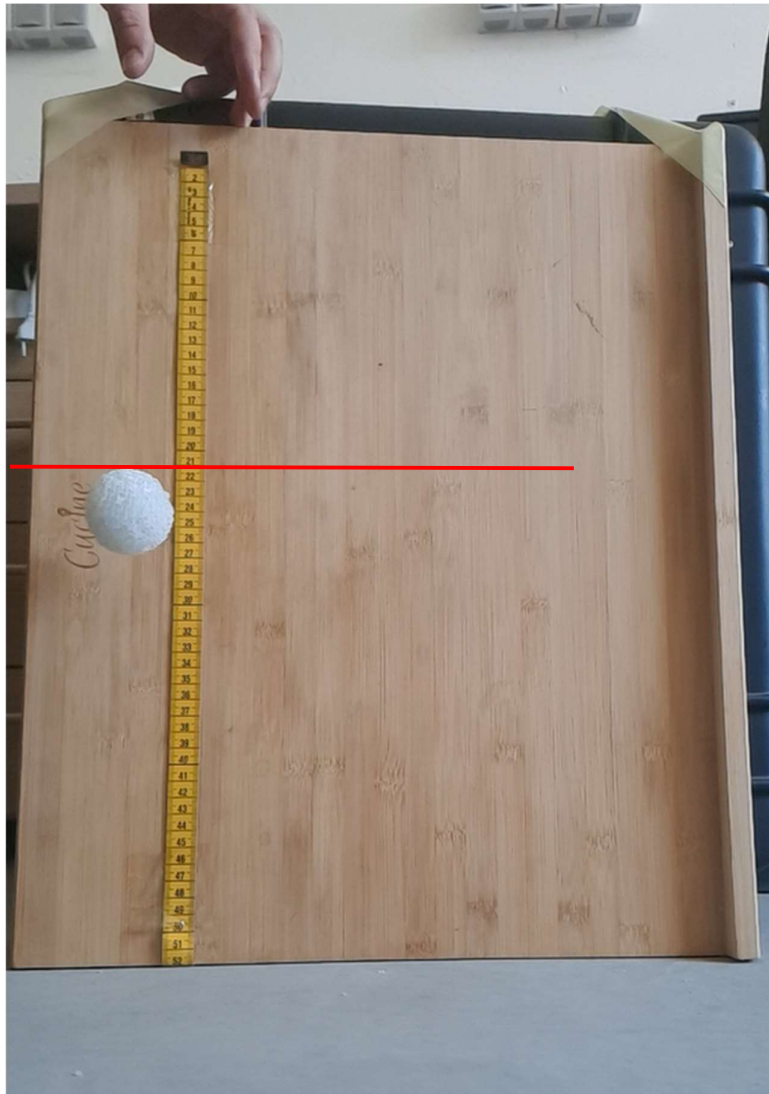
Slika 30. Loptica 2 - ispitivanje elastičnosti odbijanjem od podloge
