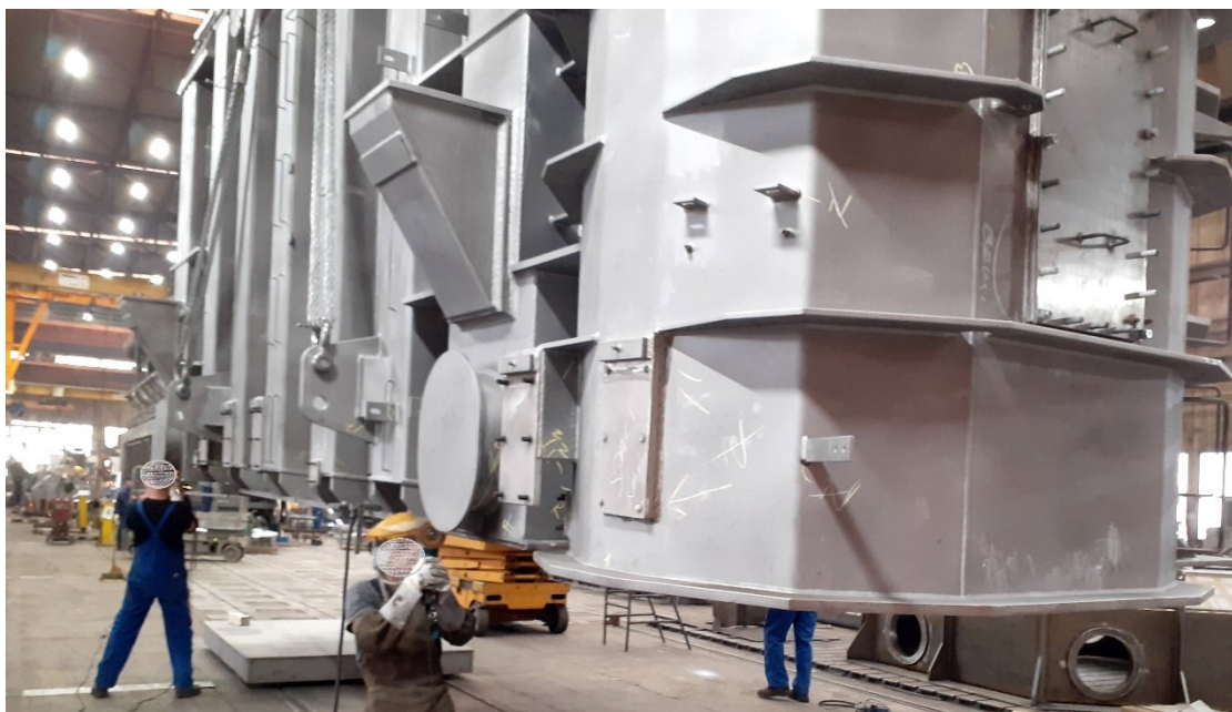
Slika 33. Završne dorade transformatorskog kotla prije čišćenja mlazom abraziva
