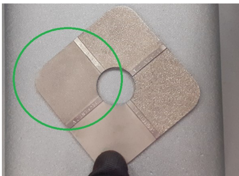
Slika 45. Komparator za kontrolu profila hrapavosti
