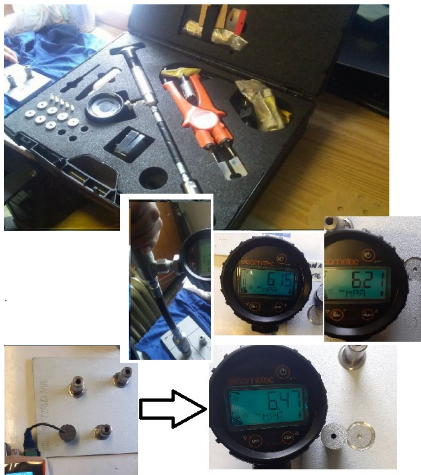
Slika 47. Pull off test
