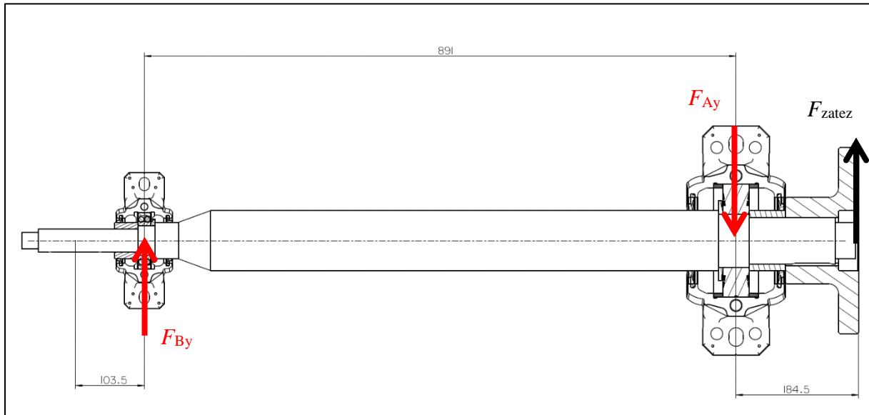
Slika 53. Opterećenje vratila u vertikalnoj ravnini
