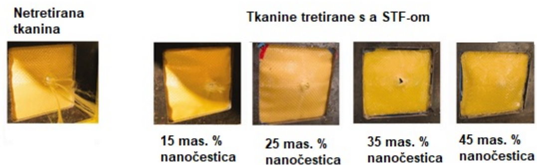
Slika 11. Morfologija Kevlar® tkanine nakon balističkih testova [58].
