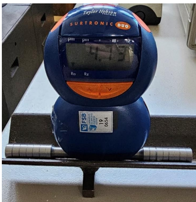
Slika 15. Mjerenje hrapavosti površine
