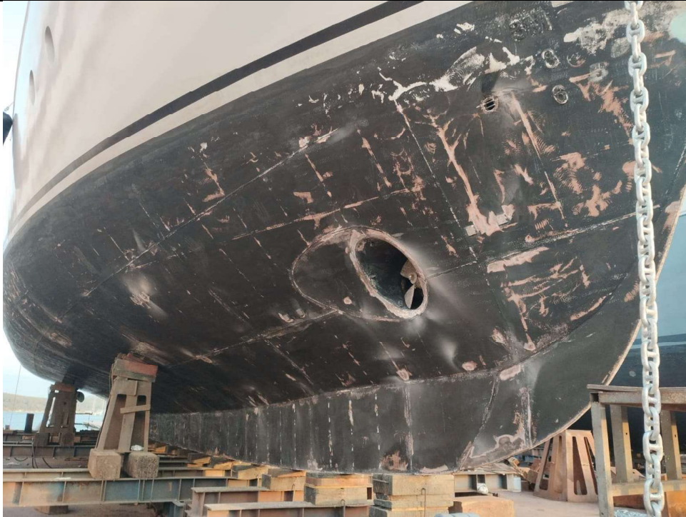
Slika 21. Priprema površine za lokalno obnavljanje premaza s topivom matricom
