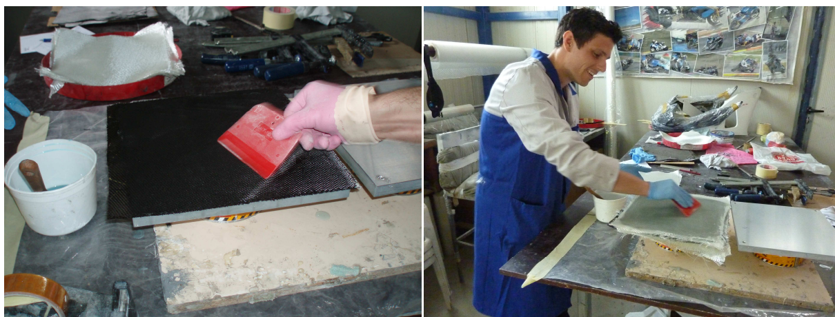
Slika 5.9. Impregniranje slojeva raznošenjem smole po površini
