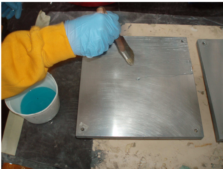
Slika 5.7. Nanošenje dvokomponentne epoksidne smole kistom na kalupne ploče
