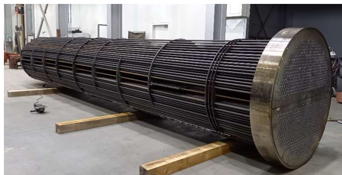
Slika 2. U-cijevni snop izmjenjivača topline (izvor: Pireko d.o.o)
