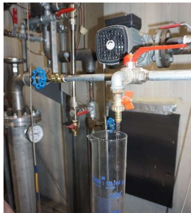
Slika 38. Igličasti ventil i izljevno mjesto s menzurom
