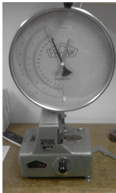
Slika 34. Uređaj za ispitivanje udarne radnje loma
