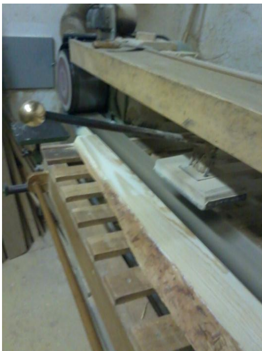
Slika 8. Strojno brušenje daske
