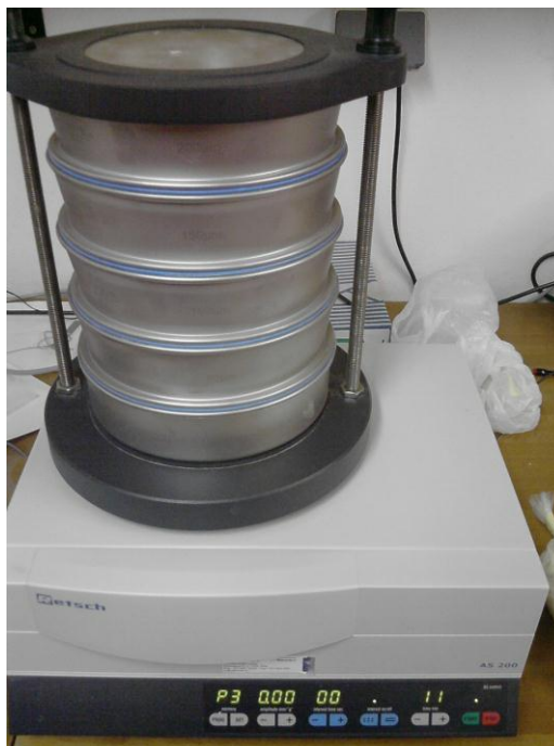
Slika 11. Uređaj za prosijavanje Retsch AS 200
