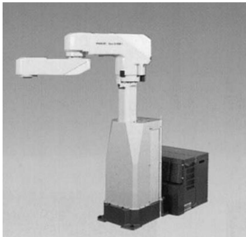
Slika 15. Robot tipa SCARA (TRR konfiguracija) [6]
