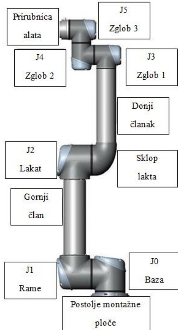
Slika 22. Sklop robotske ruke [18]
