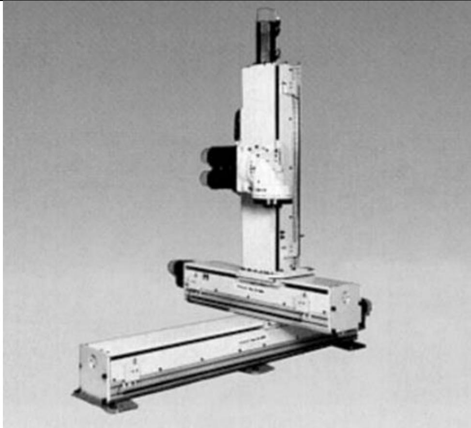
Slika 9. Prikaz industrijskog robota s pravokutnom konfiguracijom [6]
