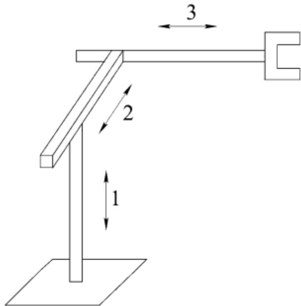
Slika 8. Shematski prikaz robota s pravokutnom konfiguracijom [6]
