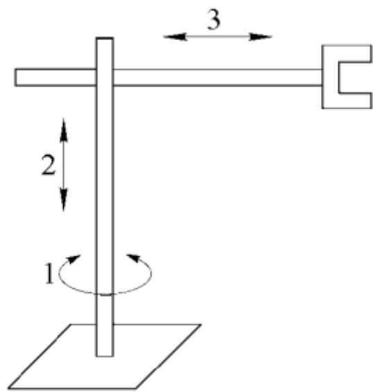
Slika 10. Shematski prikaz robota s cilindričnom konfiguracijom [6]
