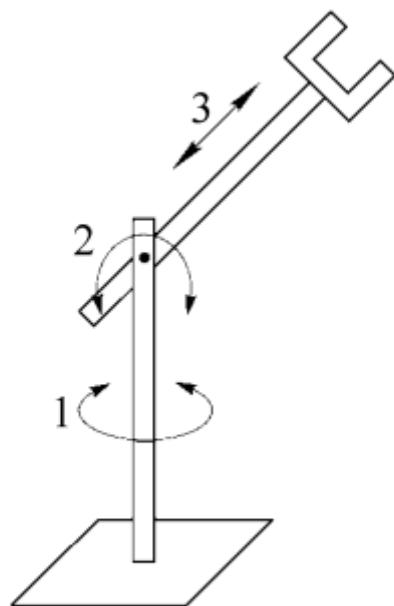
Slika 11. Shematski prikaz robota sa sfernom konfiguracijom [6]
