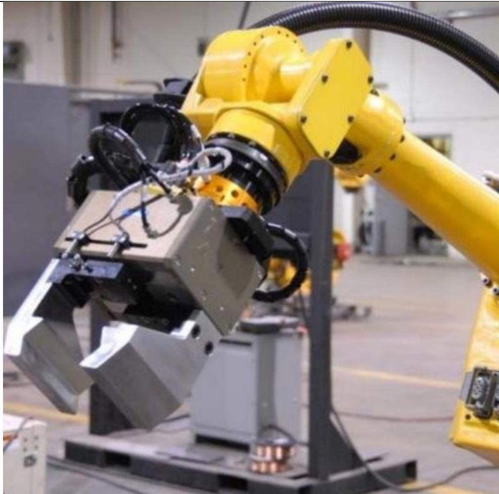
Slika 19. Hidrauličke hvataljke [17]
