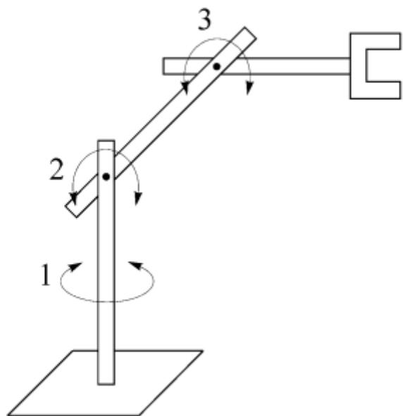
Slika 13. Shematski prikaz robota s rotacijskom konfiguracijom [6]
