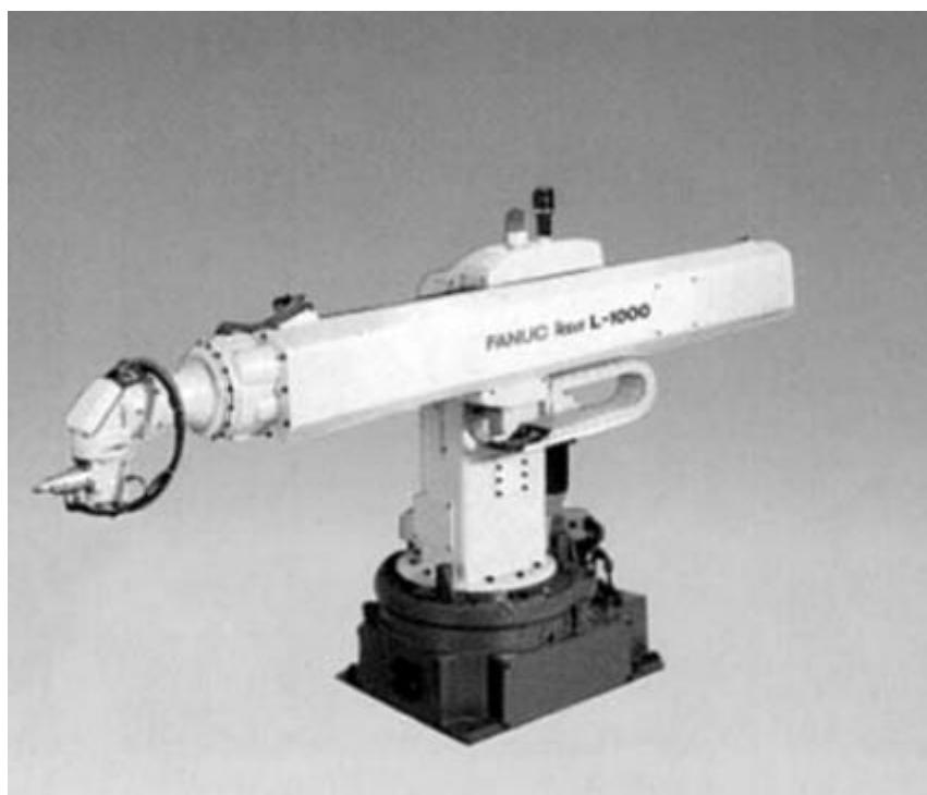
Slika 12. Prikaz industrijskog robota sa sfernom konfiguracijom [6]
