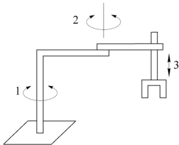
Slika 14. Robot tipa SCARA (RRT konfiguracija) [6]
