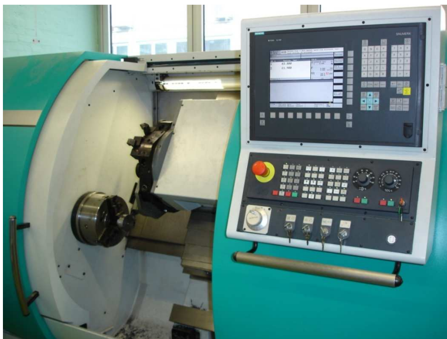
Slika 18. Radni prostor tokarskog obradnog centra Trens SBL-500
