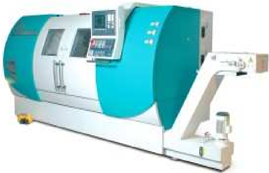
Slika 17. Tokarski obradni centar Trens SBL-500 [16]
