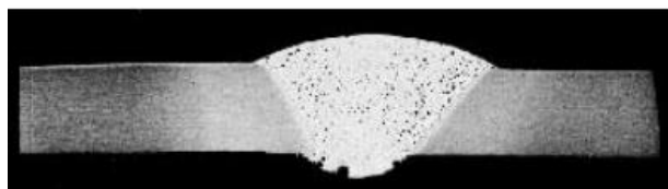
Slika 5. Poroznost u TIG zavaru ploče debljine 6 mm [5]
