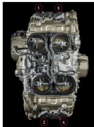
Slika 8: Twin Pulse redoslijed paljenja [4]
