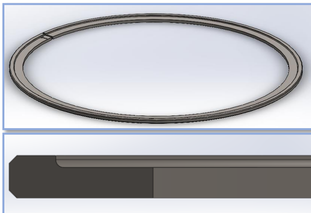
Slika 68: CAD model 1. kompresijskog prstena
