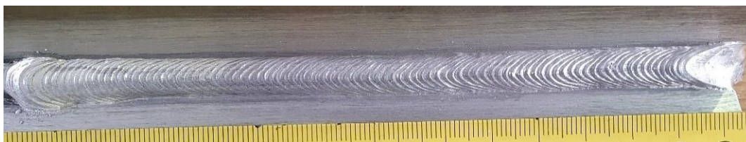
Slika 44. Naličje kutnog zavara B1 izvedenog u zaštiti argona s 50% helija uz f=8 Hz
