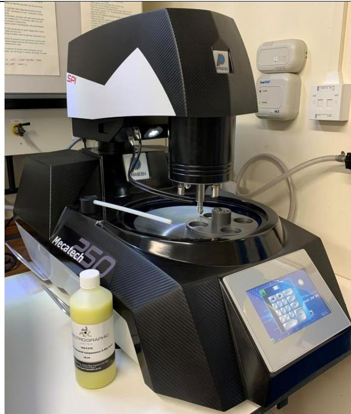
Slika 50. Uredaj za poliranje uzorka Presi Mecatech 250 SPI
