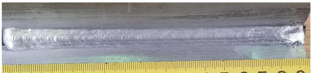
Slika 48. Naličje kutnog zavara B3 izvedenog u zaštiti argona s 50% helija uz  $f=32$  Hz
