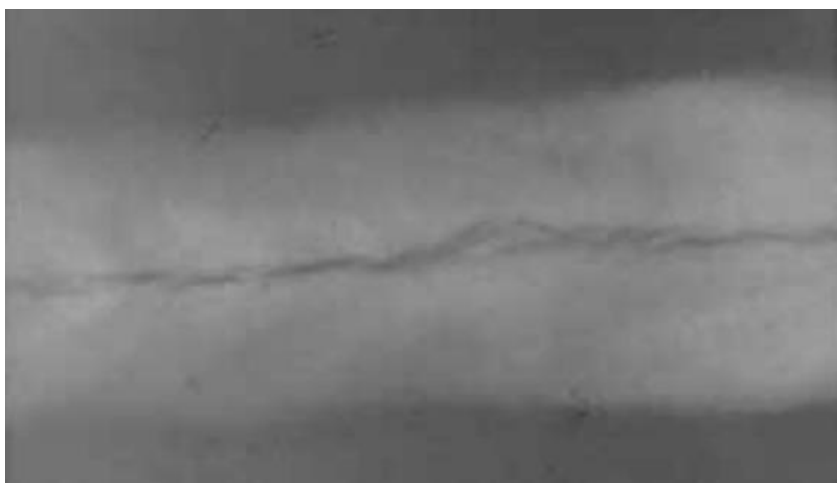
Slika 32. Radiografska snimka uzdužne pukotine zavara aluminija [8]
