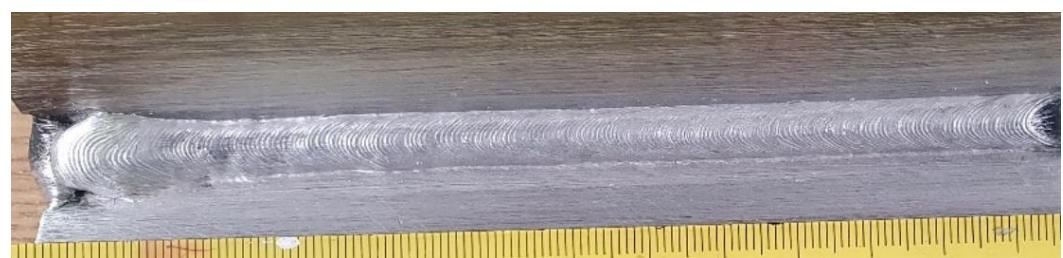
Slika 45. Naličje kutnog zavara A2 izvedenog u zaštiti 100% argona uz f=20 Hz
