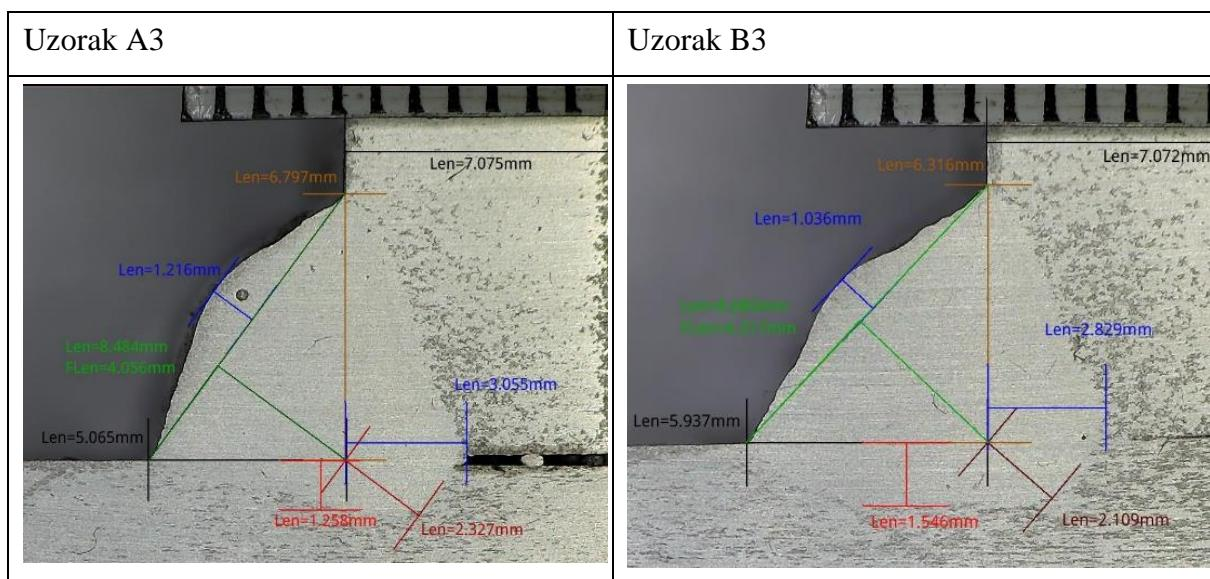
U tablici 12. je prikazana usporedba izmjerena vrijednosti geometrije zavara makroizbrusaka A3 i B3.
