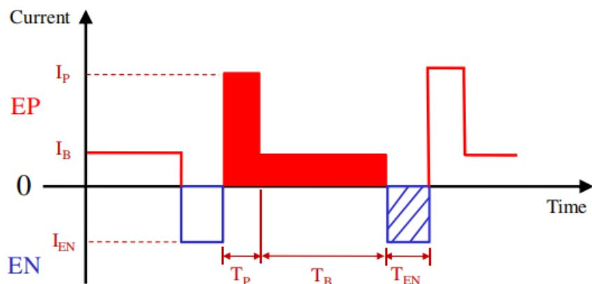
**Slika 5. Valni oblik struje kod impulsnog AC MIG zavarivanja [10]**
