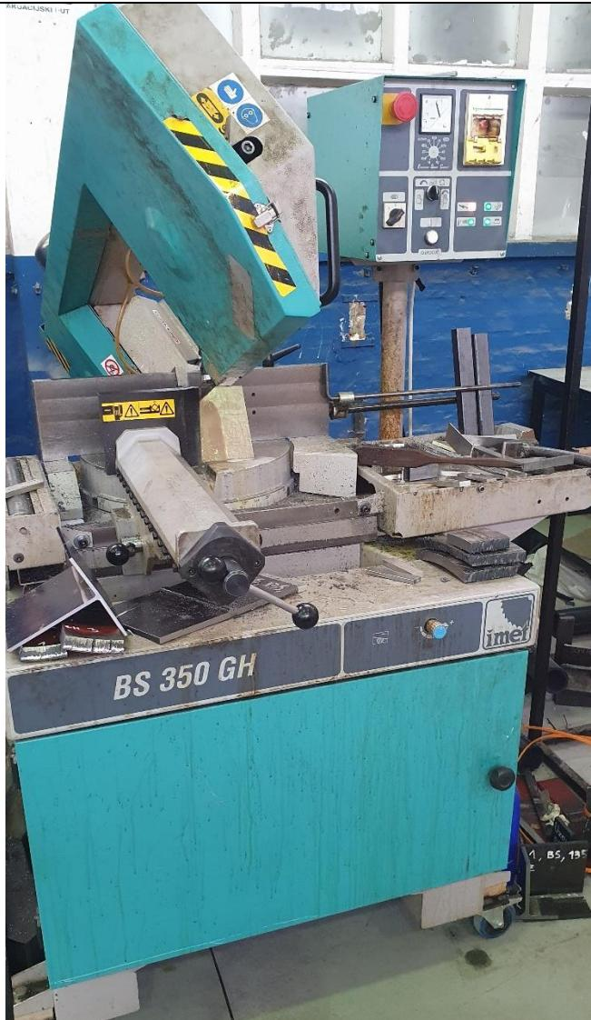
**Slika 49. Tračna pila imet BS 350 GH**
