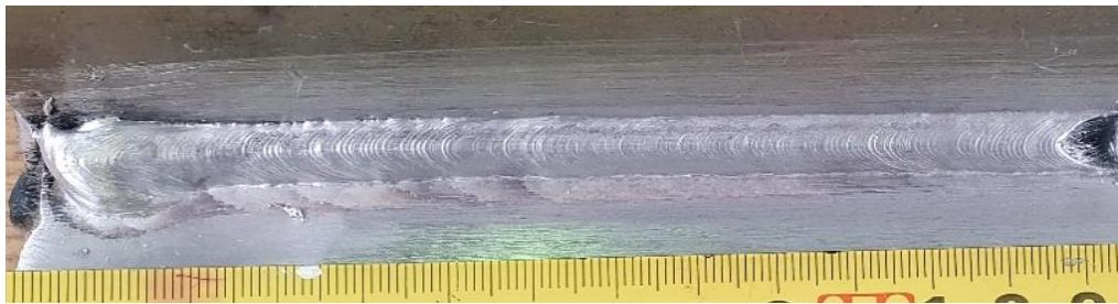
Slika 47. Naličje kutnog zavara A3 izvedenog u zaštiti 100% argona uz  $f=32$  Hz
