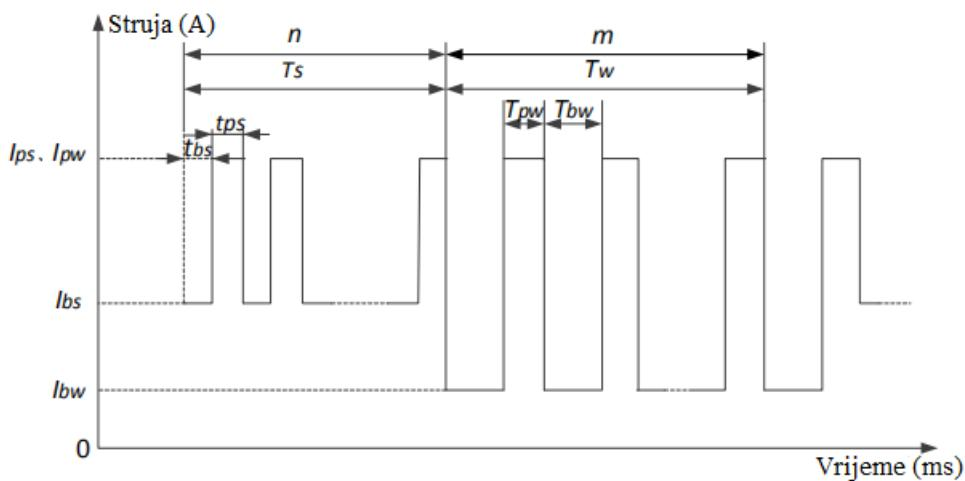
**Slika 10. Oblik vala kod AC Wave impulsnog zavarivanja [15]**
