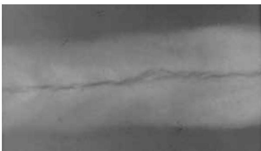
Slika 32. Radiografska snimka uzdužne pukotine zavara aluminija [8]
