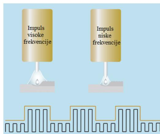
**Slika 9. Valni oblik superponiranog niskofrekventnog vala [14]**
