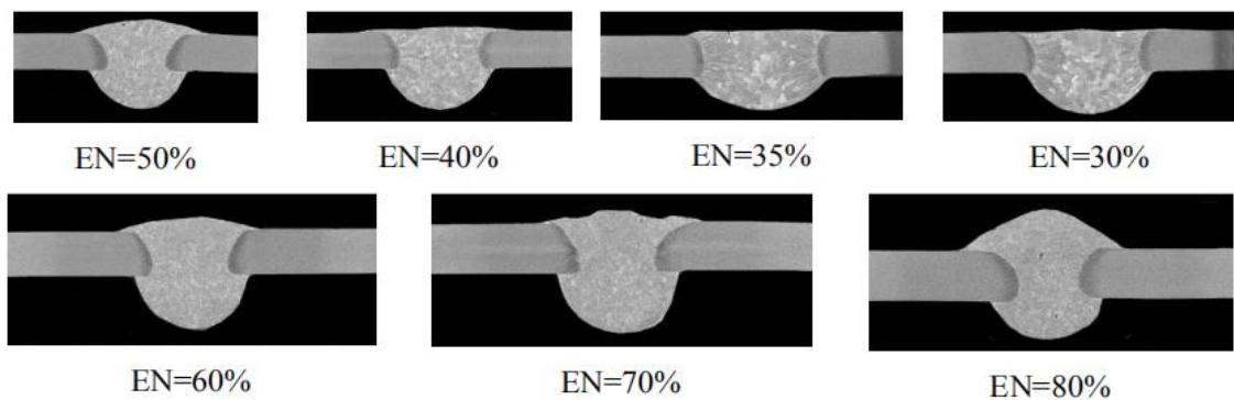
**Slika 20. Profili zavarenih spojeva izvedenih AC MIG-P postupkom uz različite EN omjere negativne komponente [21]**
