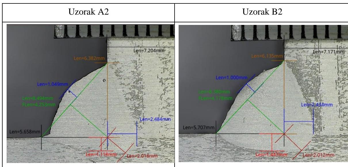
U tablici 10. je prikazana usporedba izmjerjenih vrijednosti geometrije zavara makroizbrusaka A2 i B2.
