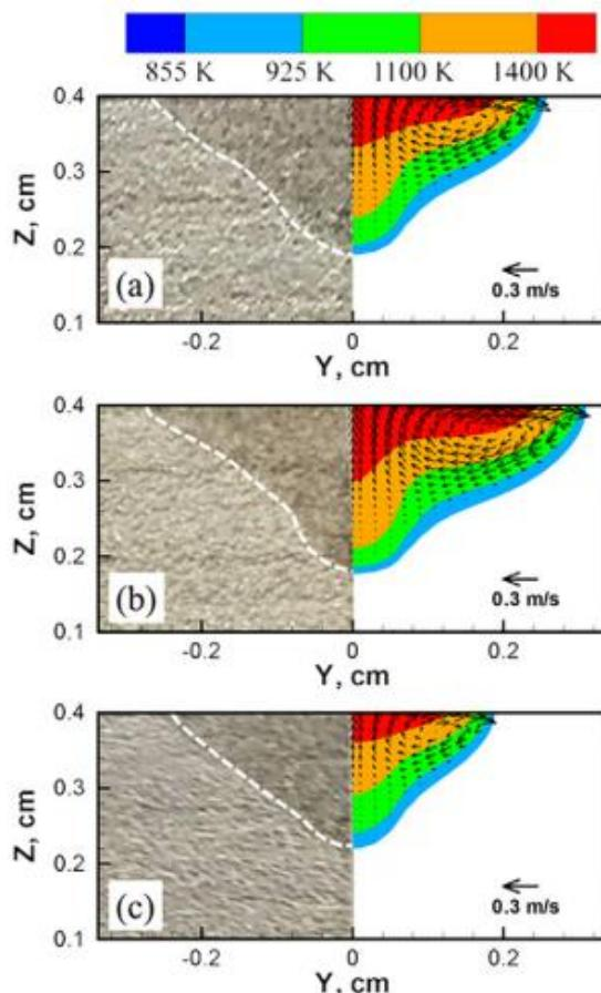
**Slika 28. (a) Poprečni presjek zavara kod AC impulsnog MIG postupka, (b) Najveći poprečni presjek zavara kod AC Wave impulsnog MIG postupka, (c) Najmanji poprečni presjek zavara kod AC Wave impulsnog MIG postupka [23]**
