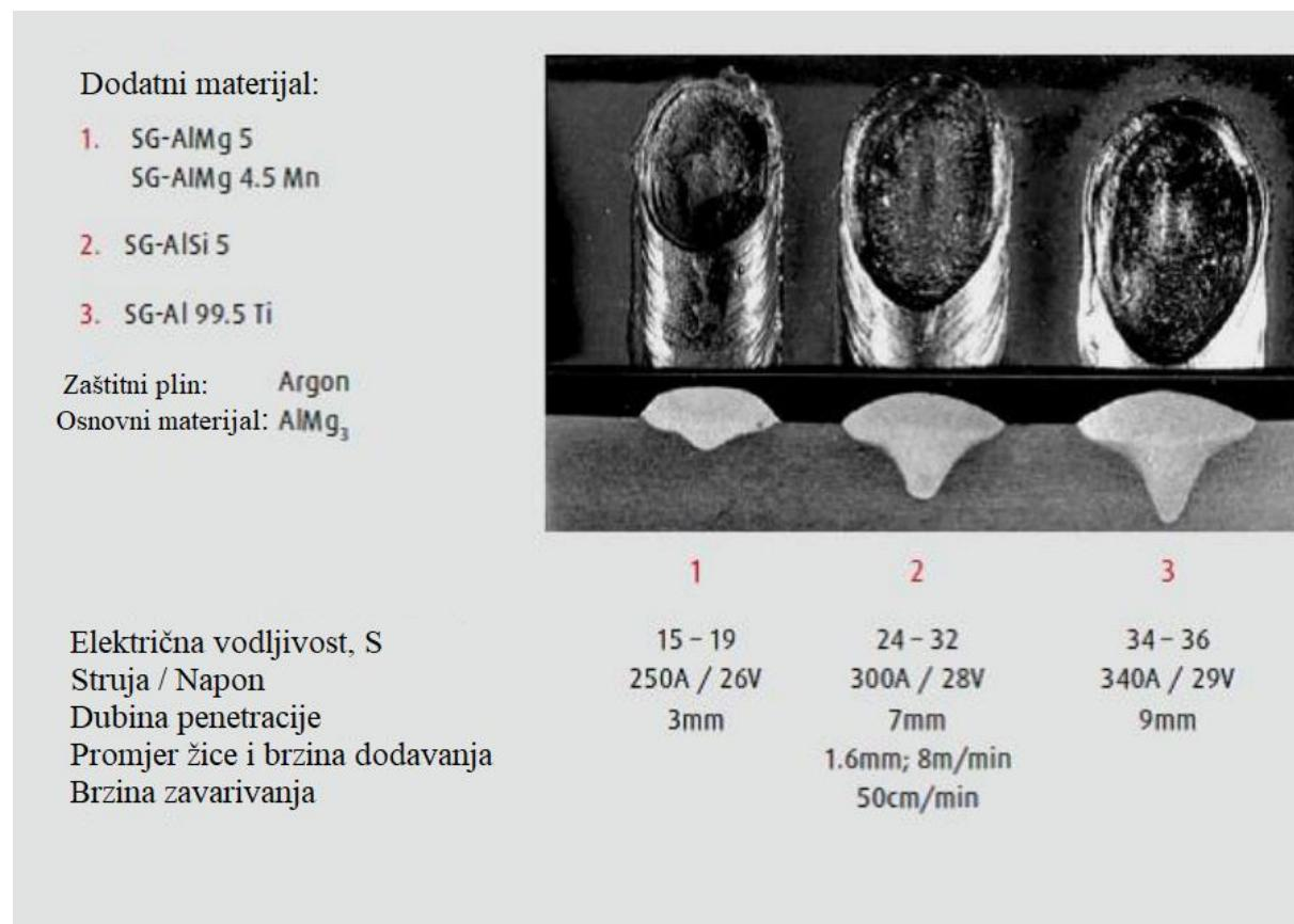
**Slika 30. Utjecaj električne vodljivosti na geometriju zavara kod MIG zavarivanja aluminija [25]**
