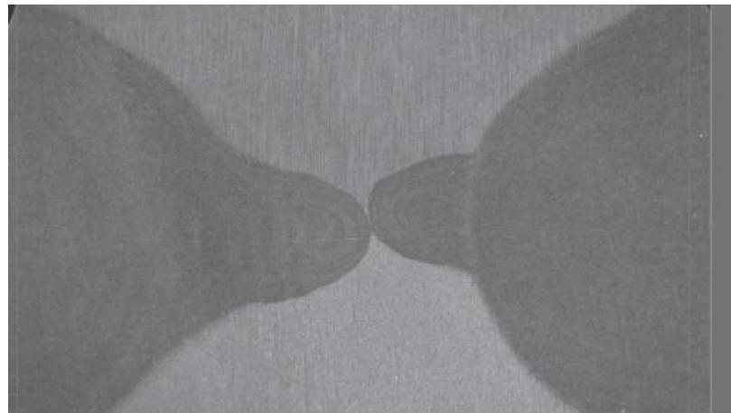
Slika 33. Presjek dvostranog zavara s nepotpunim provarom [8]
