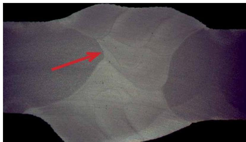
Slika 34. Makroizbrusak zavara s vidljivim naljepljivanjem [8]
