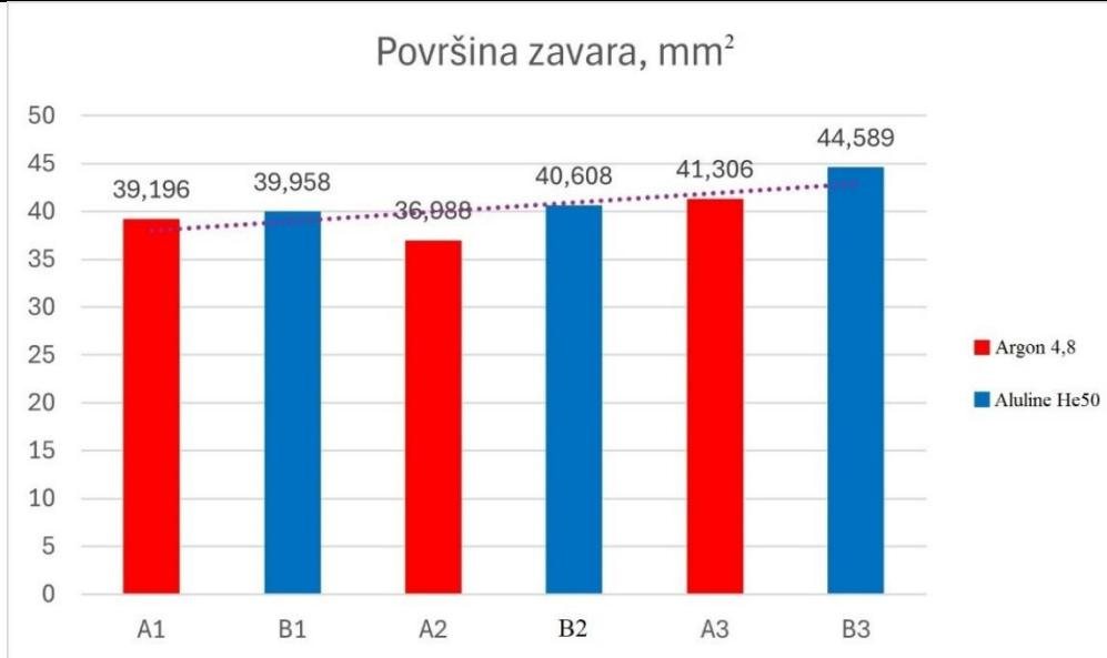
Slika 63. Grafički prikaz promjene površine zavara
