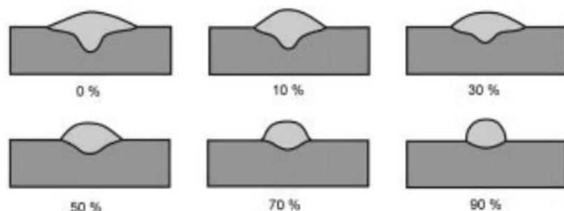
**Slika 2. Izgled profila zavara pri AC MIG zavarivanju korištenjem različitog omjera negativnog polariteta od 0% do 90% [7]**
