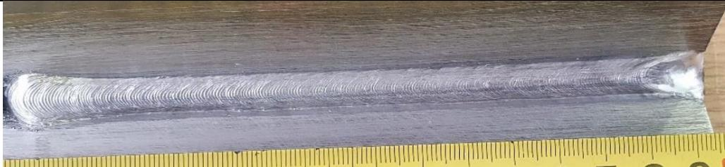
Slika 46. Naličje kutnog zavara B2 izvedenog u zaštiti argona s 50% helija uz  $f=20$  Hz
