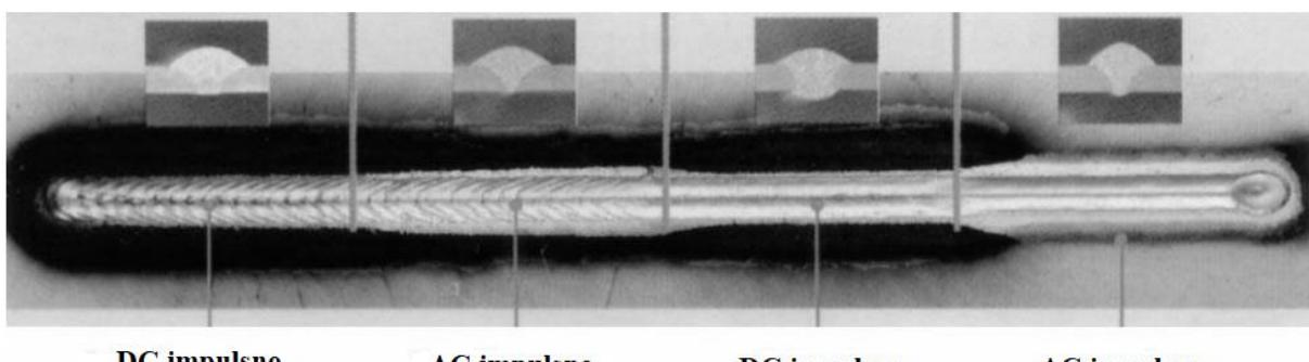
**Slika 22. Utjecaj promjena načina zavarivanja iz DC u AC na kontinuiranom zavarenom spoju uz konstantnu brzinu zavarivanja [3]**
