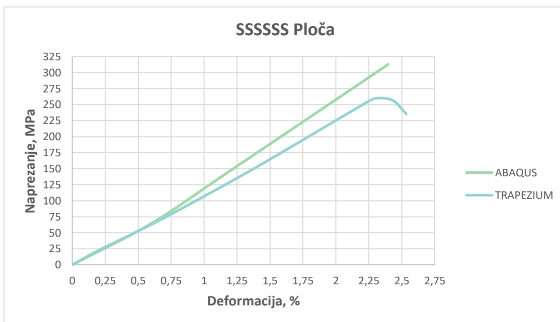
Slika 46. Usporedba dijagrama savojno napreznja-istezanje u Abaqusu i Trapeziumu za ploču SSSSSS
