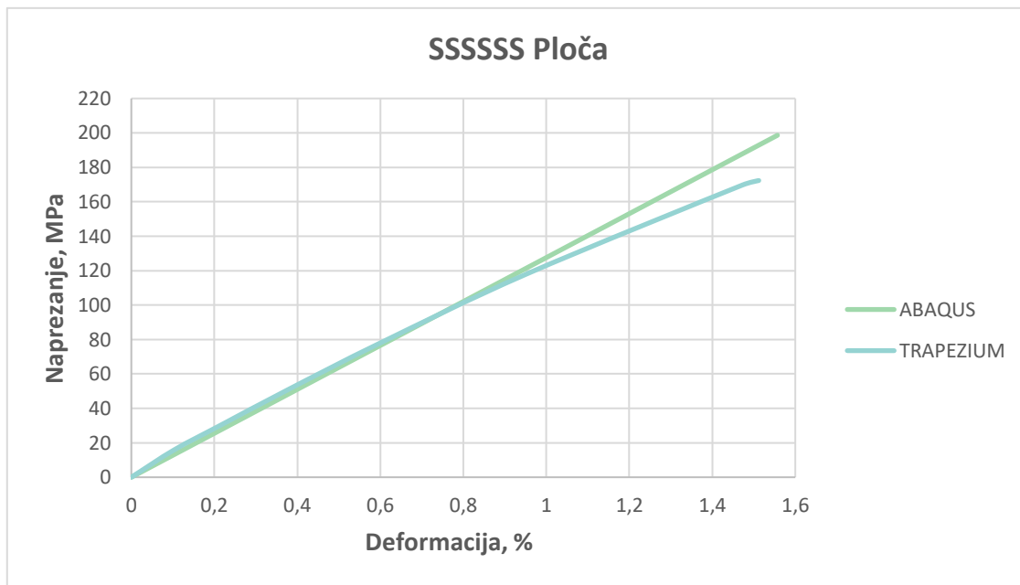
Slika 41. Usporedba dijagrama rastezno naprezanje-istezanje u Abaqusu i Trapeziumu za ploču SSSSSS
