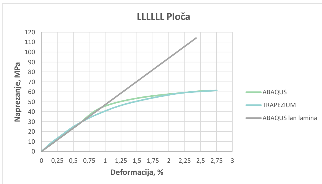
Slika 42. Usporedba dijagrama rastezno naprezanje-istezanje u Abaqusu i Trapeziumu za ploču LLLLLL
