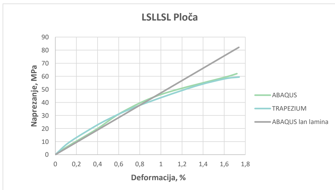
Slika 39. Usporedba dijagrama rastezno naprezanje-istezanje u Abaqusu i Trapeziumu za ploču LSLLSL
