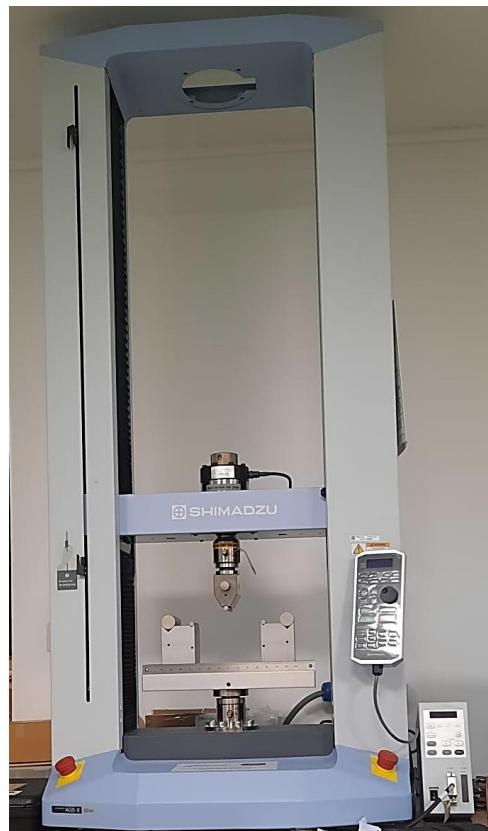
**Slika 12.** Kidalica Shimadzu AGS-X
