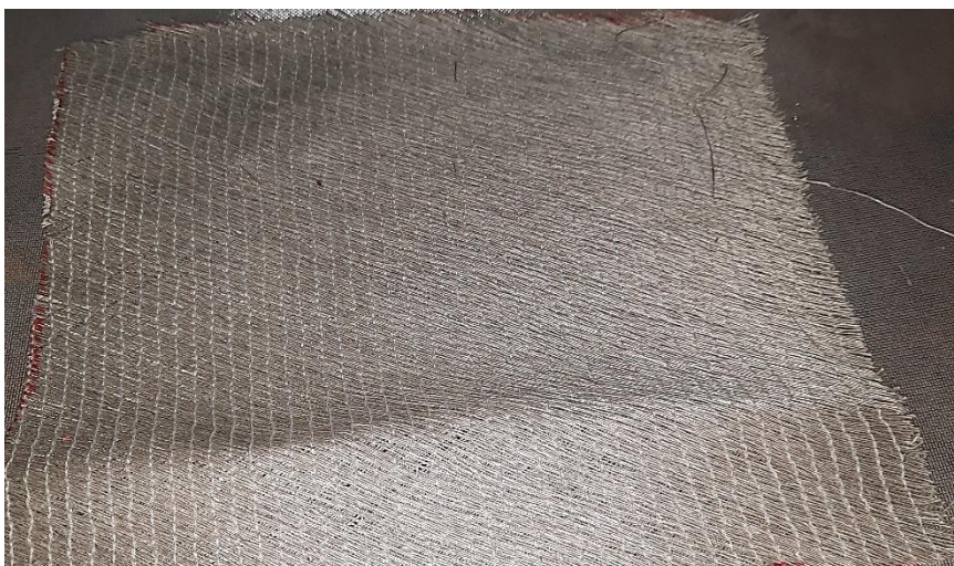
Slika 8. Tkanina lanenih vlakana pod kutom \pm 45^\circ
