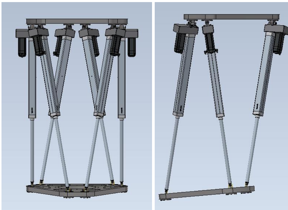
Slika 64. Položaj platforme za FEM analizu nepomične ploče
