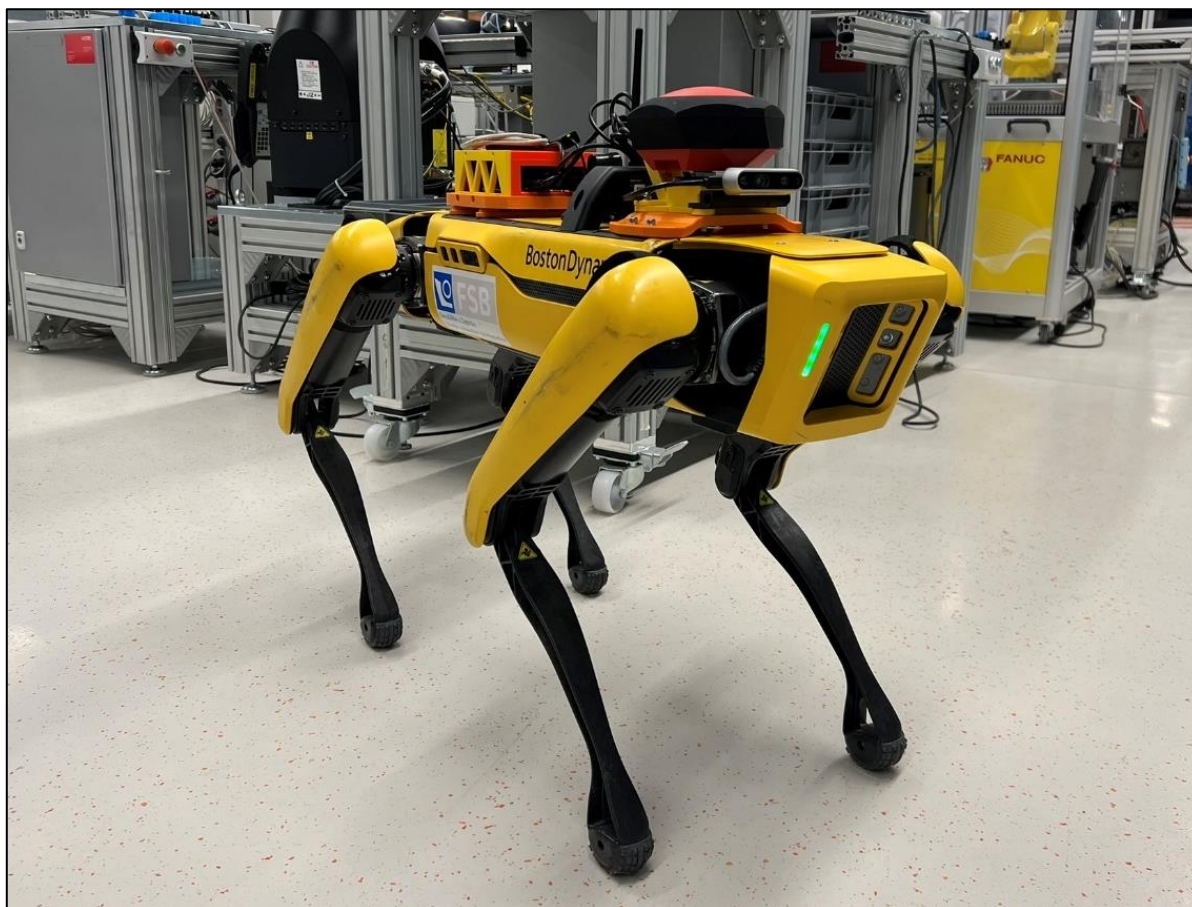
Slika 29. Oprema postavljena na Spot robota
