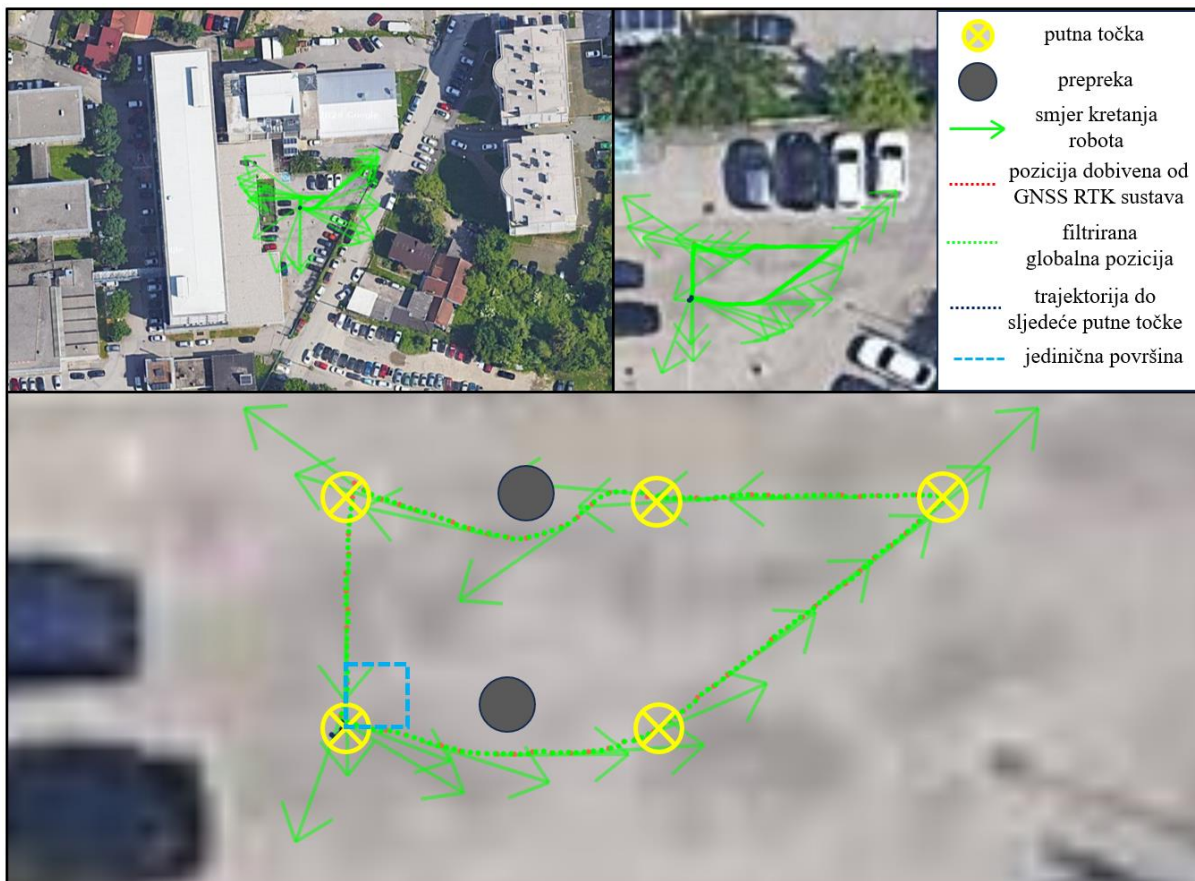
Slika 46. Praćenje putnih točaka Spot mobilnog robota s dvije postavljene prepreke prikazano u videu [86]
