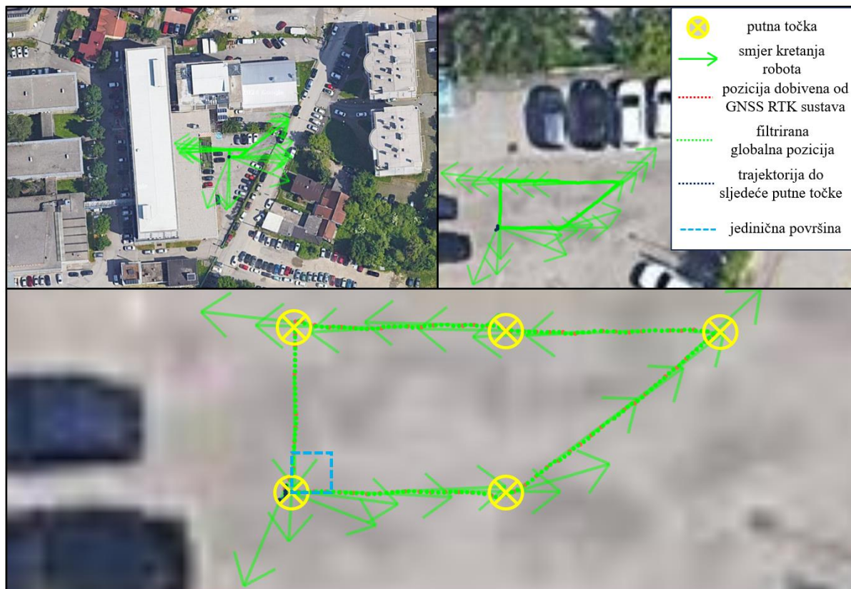
Slika 44. Praćenje putnih točaka Spot mobilnog robota bez postavljenih prepreka prikazano u videozapisu [84]
