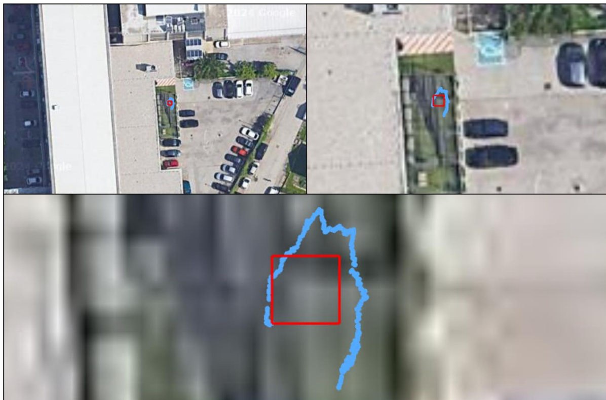
Slika 10. Rasipanje podataka globalne pozicije u slučaju korištenja rovera bez primjene korekcijskih podataka
