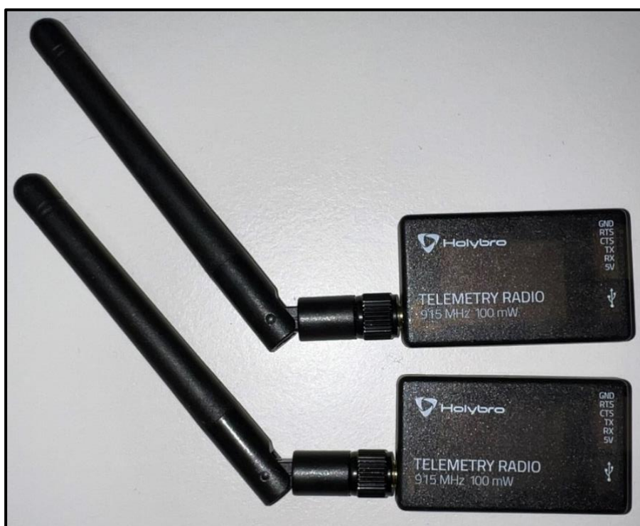
Slika 6. Holybro odašiljač/prijamnik za slanje korekcijskih podataka između baze i rovera
