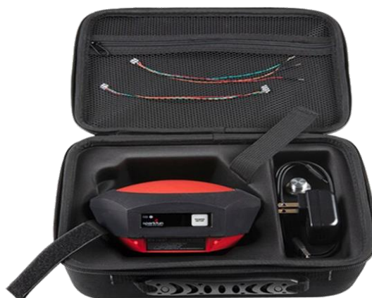
Slika 4. SparkFun RTK Facet integrirani sustav [15]
