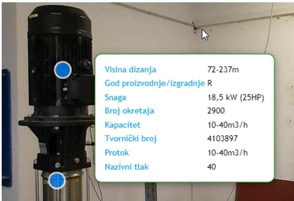
Slika 34. Prikaz tehničkih specifikacija putem interaktivnog prozora
