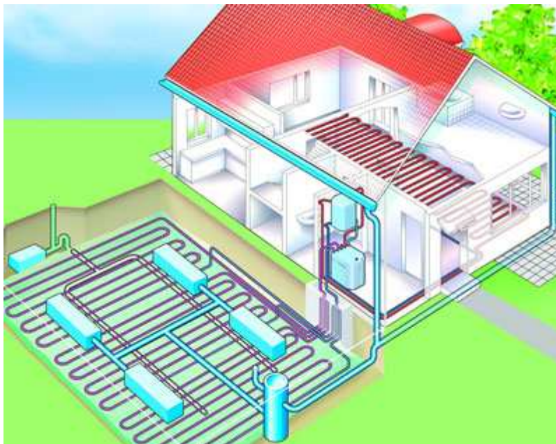
Slika 13. Dizalica topline spojena na sustav podnog grijanja
