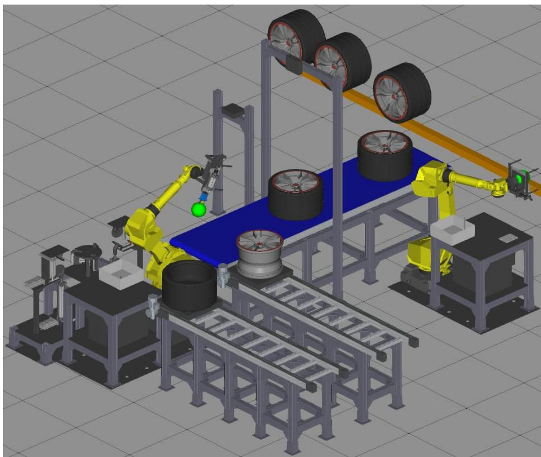
Slika 63. Oblikovani demontažni sustav u programskom paketu Roboguide
