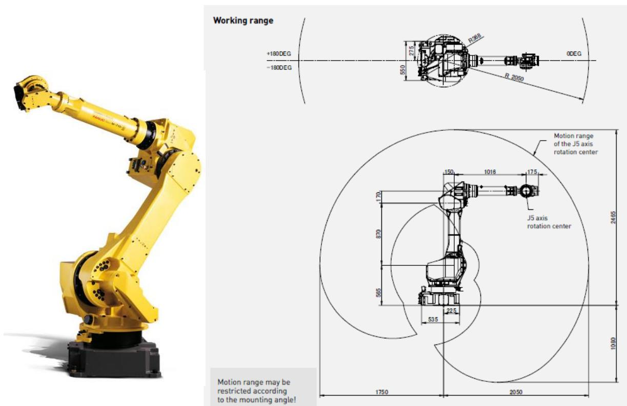
**Slika 50. Robot Fanuc M-710iC/70 i njegov radni prostor [32]**
