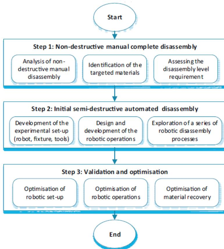
Slika 10. Opći prikaz projektiranja automatskog demontažnog sustava [13]
