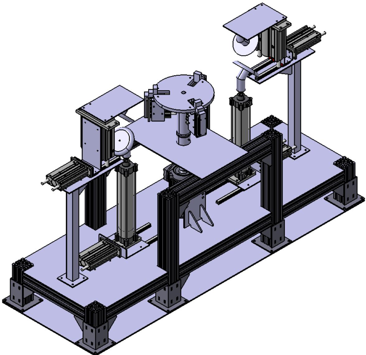
**Slika 49. Konstruirani stroj za demontažu gume s kotača**
