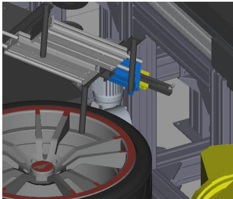
Slika 69. Uklanjanje ventila
