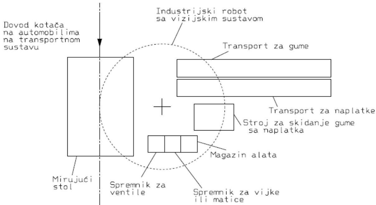
**Slika 20. Shema demontažnog sustava s jednim robotom**
