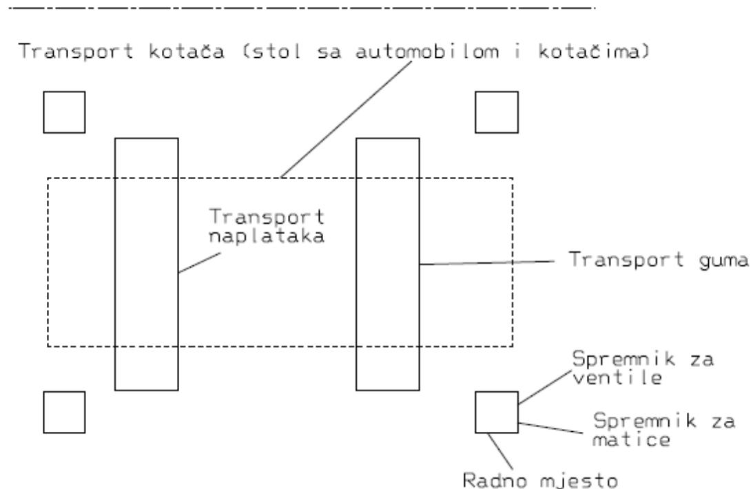
**Slika 17. Shema ručnog demontažnog sustava**
