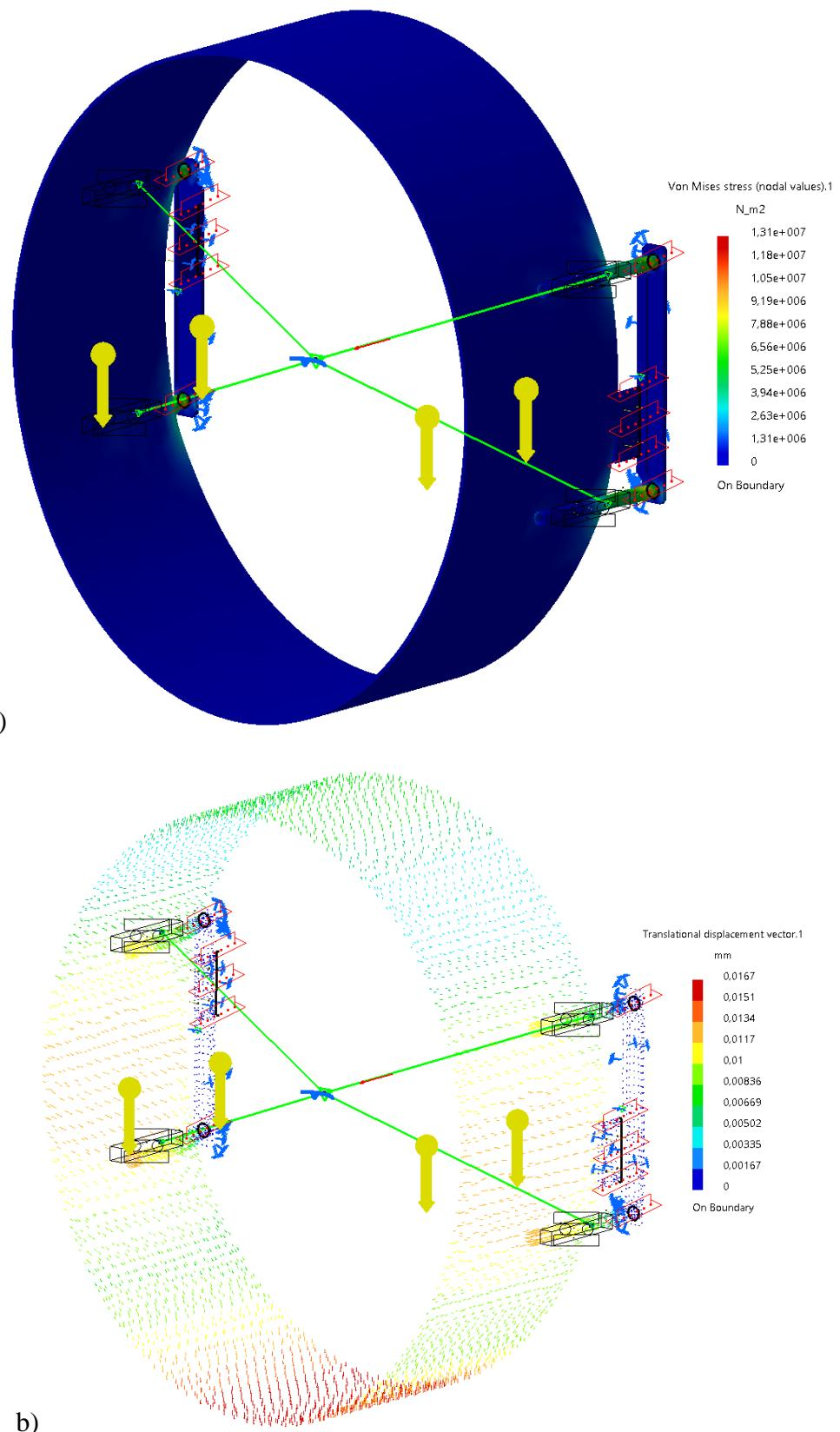
**Slika 41. FEM analiza za gravitaciju okomitu osi prirubnice robota: a) naprezanje prstiju, b) pomaka prstiju**
