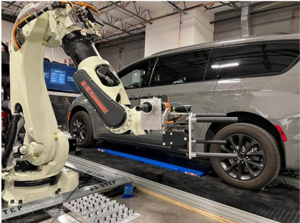
Slika 11. Robotski sustav RoboTire za izmjenu automobilskog kotača [15]
