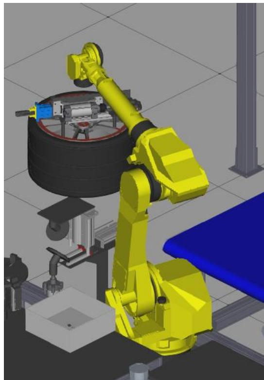
Slika 71. Manipulacija kotačem na stroj za demontažu kotača
