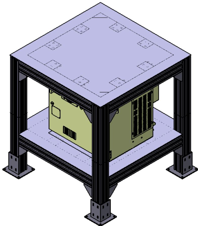
**Slika 29. Sklop stola robotskog kontrolera**
