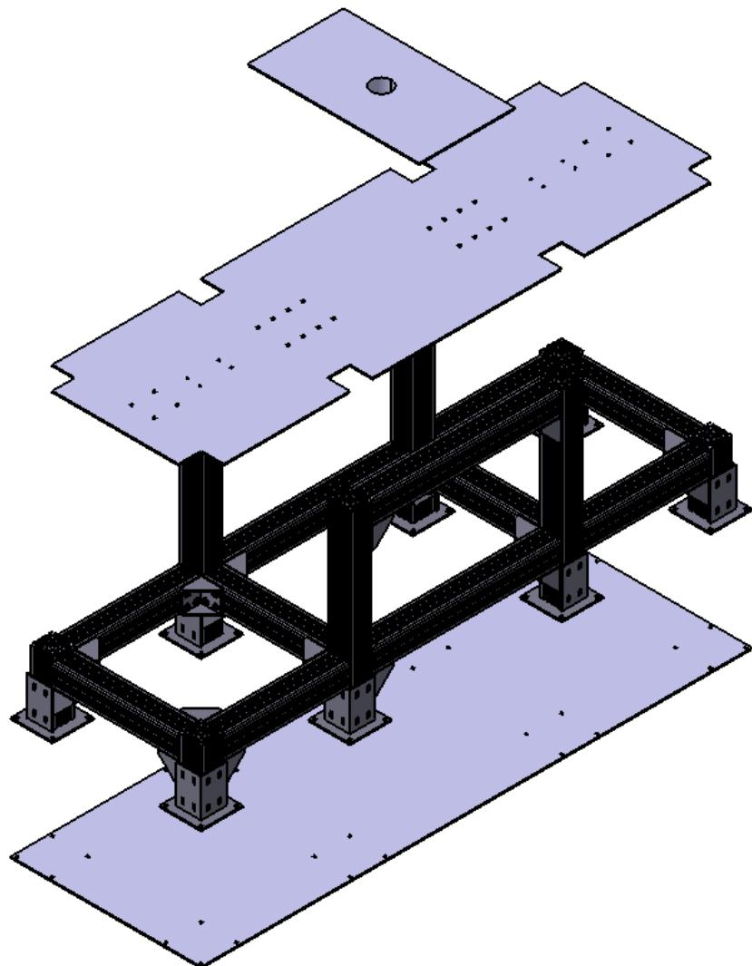
Slika 44. Nosivi elementi stroja za demontažu kotača
