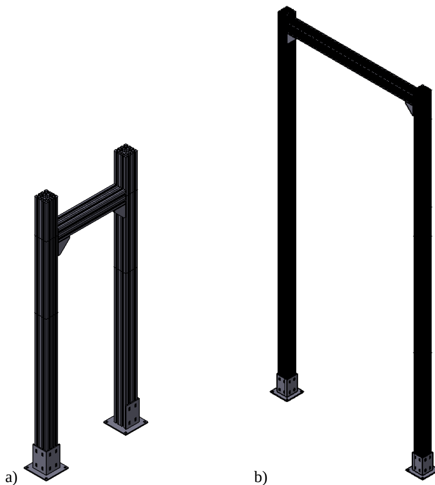
Slika 31. Nosač kamere: a) za prvu radnu stanicu, b) za drugu radnu stanicu
