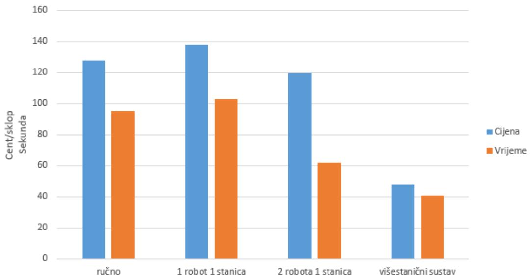
Slika 25. Rezultati analiza demontažnih sustava: cijene i vremena demontaže
