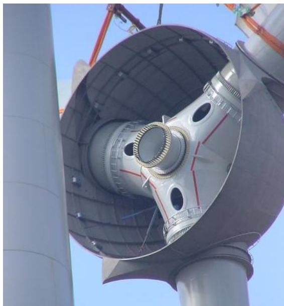
Slika 3.6 Pogled u unutrašnjost glavine rotora na vjetroturbini Enercon E126 [G]
