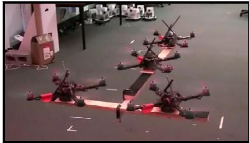
1.11 Četverorotorni helikopteri GRASP labaratorijski prenose konstrukcijski element [8]
