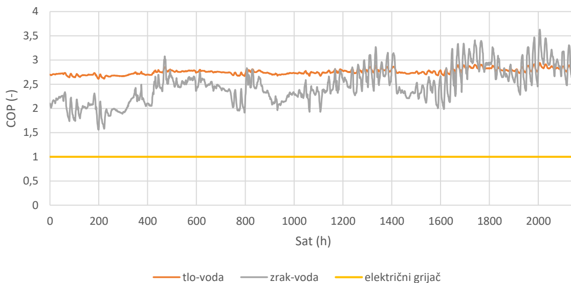
Slika 32 Učinkovitost sustava u režimu pripreme PTV-a u prvom tromjesečju
