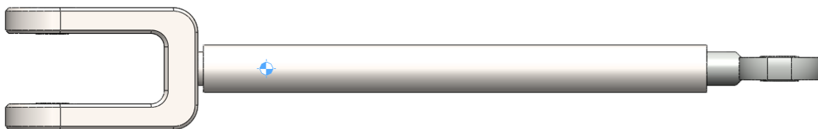
Slika 50. Izvedba štapa 4 s naznačenim težištem
