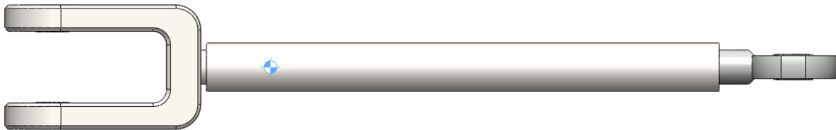
Slika 50. Izvedba štapa 4 s naznačenim težištem
