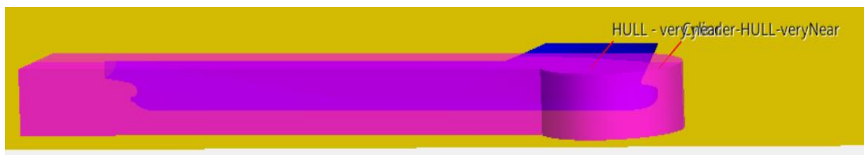
Slika 29. Volumetrijska profinjenja oko trupa modela broda nakon postavljanja modela broda na određeni kut trima
