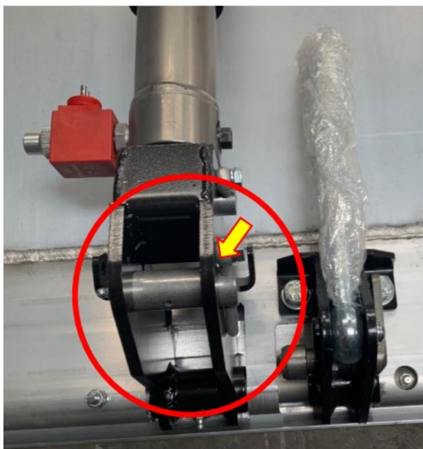
Slika 8. Svornjak zglobnog spoja
