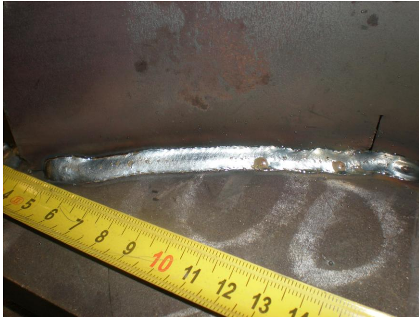
Slika 4.62 Izgled zavara uzorka 3 kutnog spoja u području prije ureza
