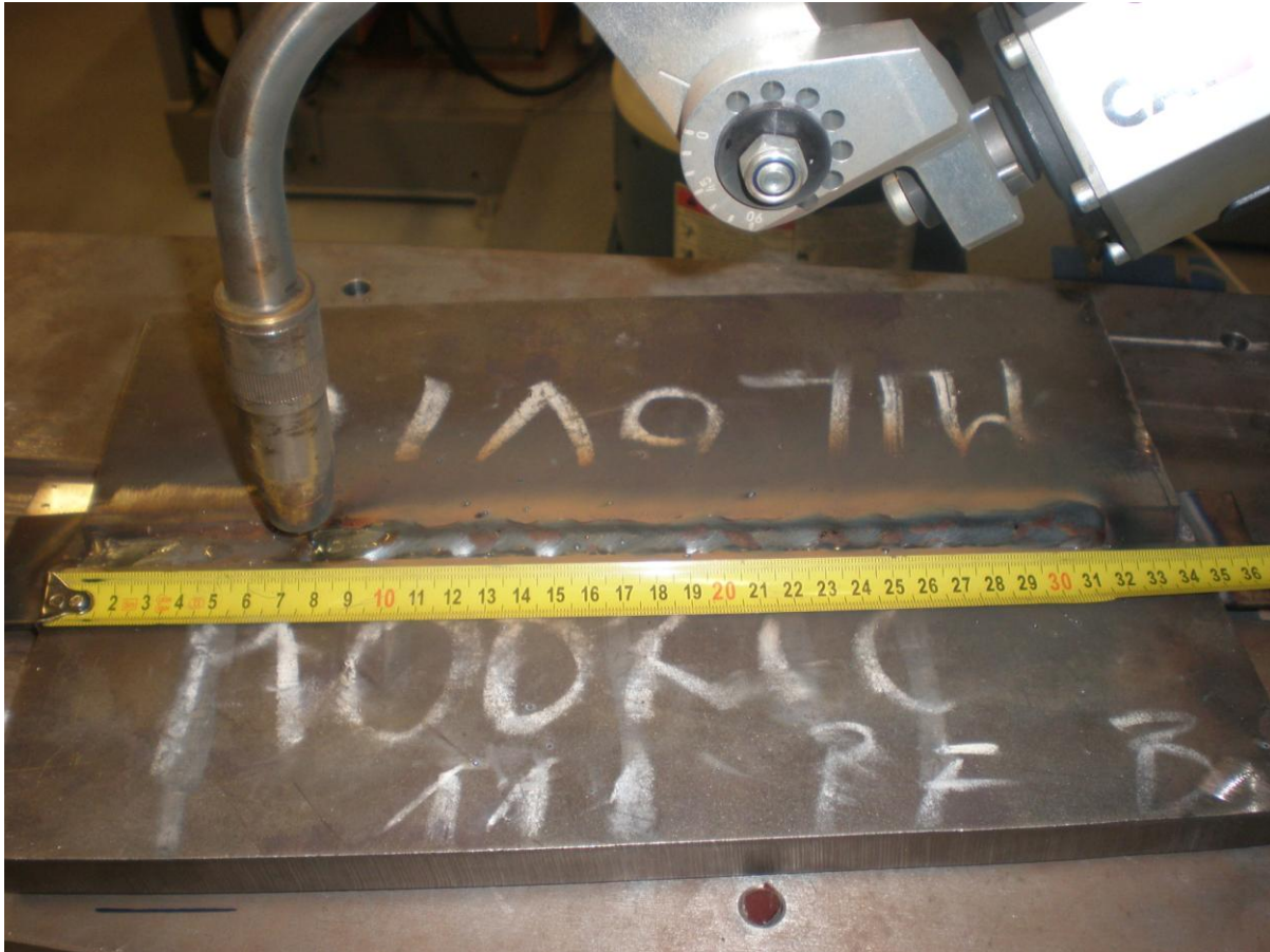
Slika 4.37 Mjesto zaustavljanja robota odnosno mjesto u kojem iznos devijacije prelazi iznos širine praćenja
