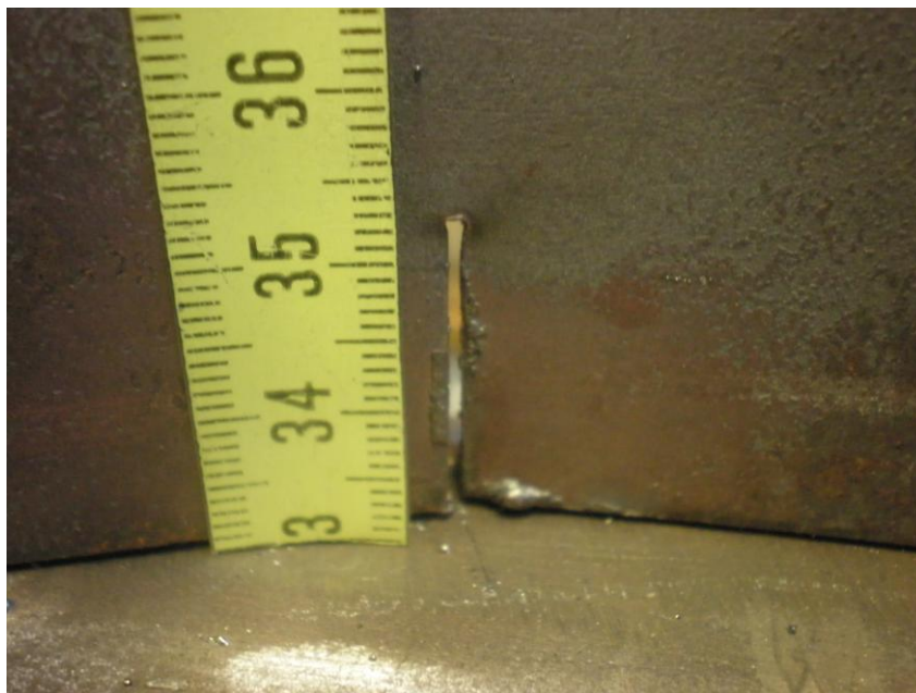
Slika 4.60 Urez kod uzorka 3 kutnog spoja
