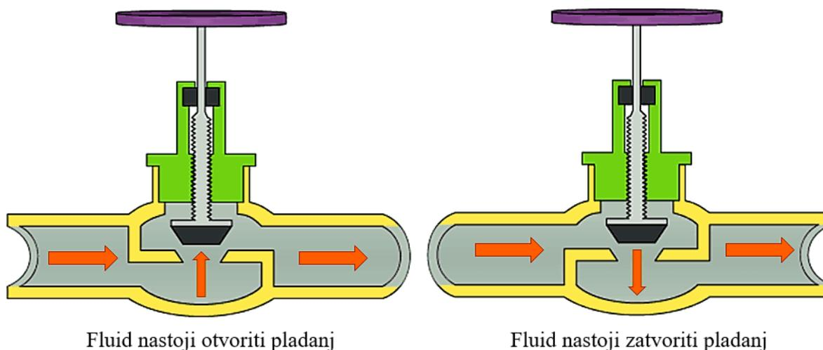
Slika 4. Podjela ventila prema smjeru gibanja fluida [4]
